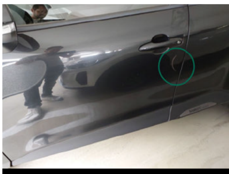
Tür / Vorne Links / Delle
