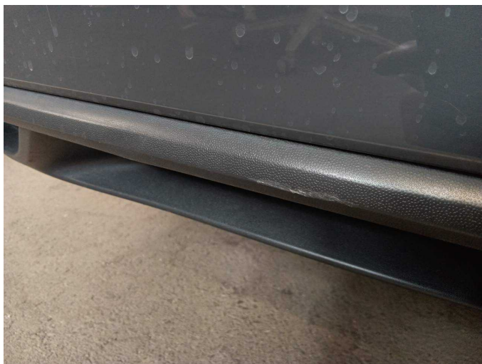
Damage 10: Rear bumper: Spoiler (Kunststoffbauteil) - Scratch(es) - Replace
