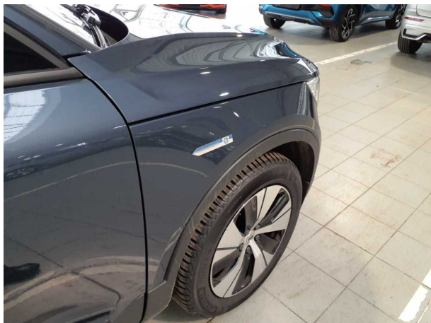
Beschädigung #1: Kotflügel rechts: Kotflügel rechts - verkratzt / verschürft - Smart Repair
