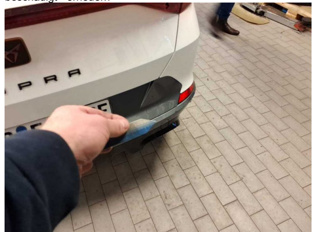
Beschädigung #11: Stossfänger hinten: Stossfänger hinten (Inkl. Spoiler.) - Delle / Lackschaden - instandsetzen und
