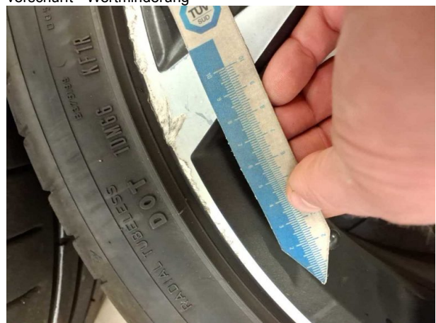
Beschädigung #7: 2.Radsatz: 1 Leichtmetallfelge - verkratzt / verschürft - Wertminderung
