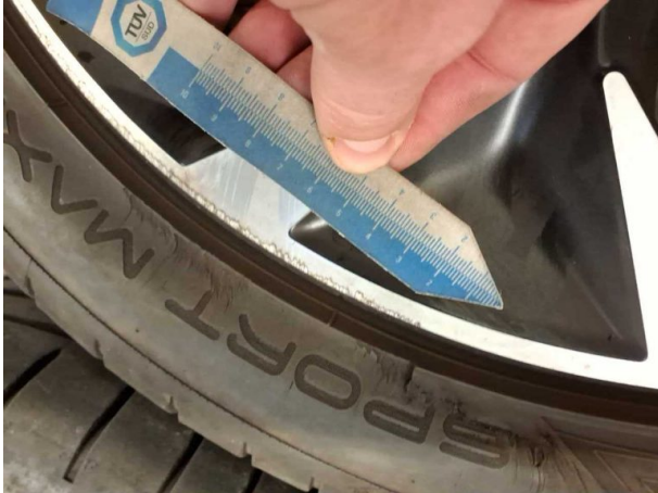
Beschädigung #9: 2.Radsatz: 1 Leichtmetallfelge - verkratzt / verschürft - Wertminderung
