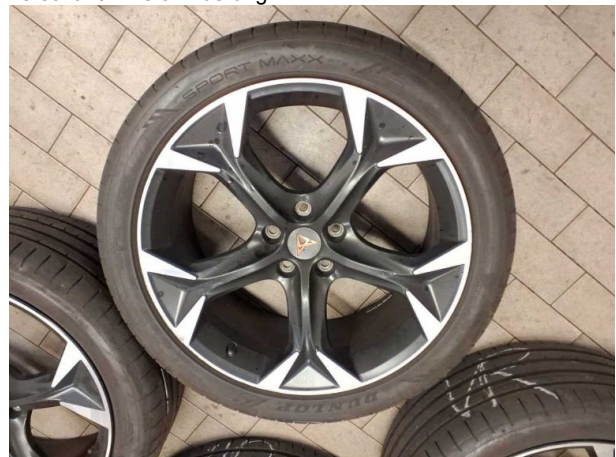
Beschädigung #7: 2.Radsatz: 1 Leichtmetallfelge - verkratzt / verschürft - Wertminderung
