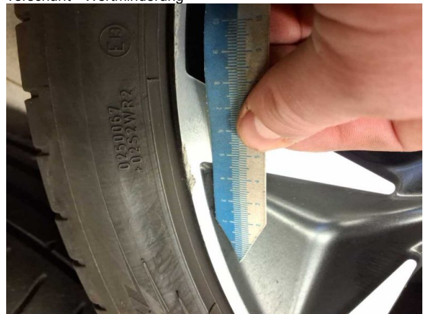
Beschädigung #8: 2.Radsatz: 1 Leichtmetallfelge - verkratzt / verschürft - Wertminderung
