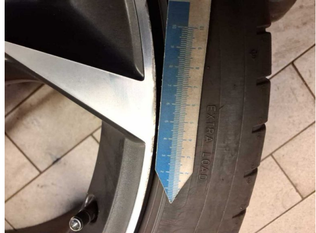
Beschädigung #8: 2.Radsatz: 1 Leichtmetallfelge - verkratzt / verschürft - Wertminderung
