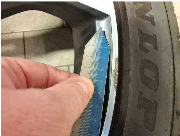
Beschädigung #6: 2.Radsatz: 1 Leichtmetallfelge - verkratzt / verschürft - Wertminderung
