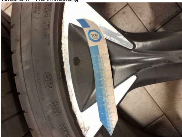
Beschädigung #7: 2.Radsatz: 1 Leichtmetallfelge - verkratzt / verschürft - Wertminderung
