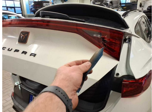
Beschädigung #10: Heckleuchte: Zusatzbremsleuchte - beschädigt - erneuern
