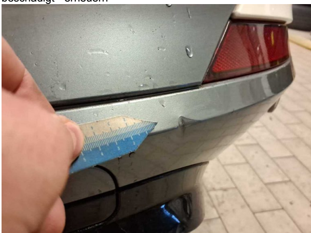
Beschädigung #11: Stossfänger hinten: Stossfänger hinten (Inkl. Spoiler.) - Delle / Lackschaden - instandsetzen und lackieren
