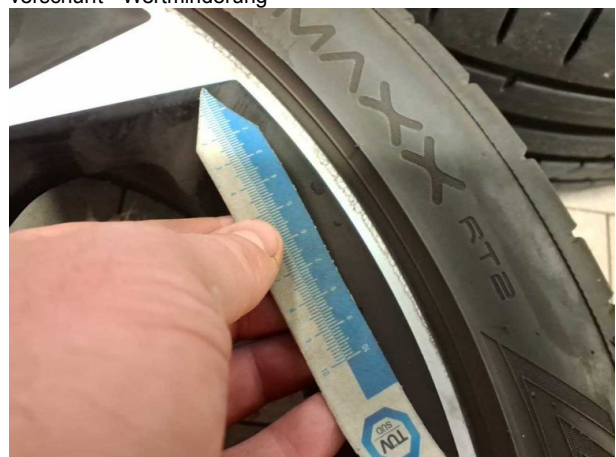
Beschädigung #9: 2.Radsatz: 1 Leichtmetallfelge - verkratzt / verschürft - Wertminderung
