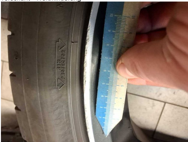
Beschädigung #8: 2.Radsatz: 1 Leichtmetallfelge - verkratzt / verschürft - Wertminderung
