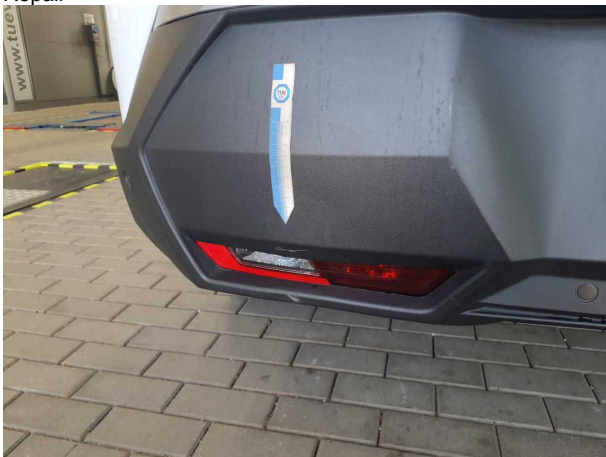
Beschädigung #2: Stossfänger hinten: Spoiler - verkratzt / verschürft - Smart Repair
