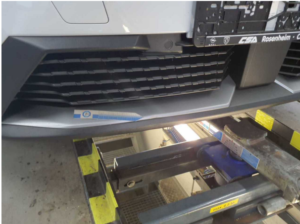
Beschädigung #1: Stossfänger vorn: Spoiler - Delle(n) - Smart Repair
