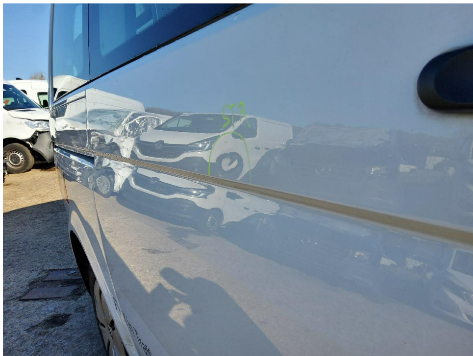
Bild 16 : Schiebetür rechts, eingedellt, drücken
