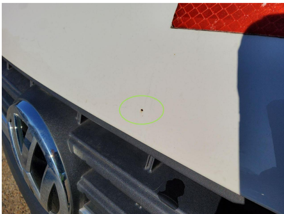
Bild 14 : Motorhaube Lackierung, Steinschlag, smart repair
