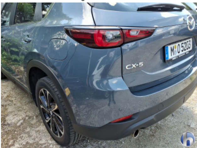
1. Seitenwand - Hinten - Links Oberflächenkratzer - Auslegen / Polieren
