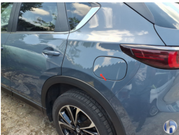
1. Seitenwand - Hinten - Links Oberflächenkratzer - Auslegen / Polieren
