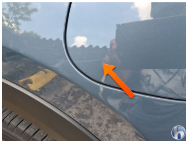
1. Seitenwand - Hinten - Links Oberflächenkratzer - Auslegen / Polieren
