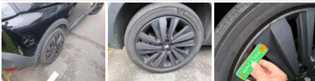
Alloy rim RL, Scratch(es), Repair/replace (lump sum)
