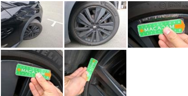
Alloy rim RR, Scratch(es), Repair/replace (lump sum)
