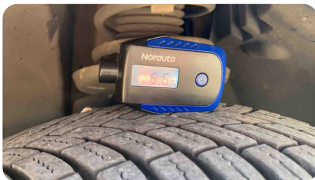
Photo de la mesure de l'usure du pneu avant gauche
