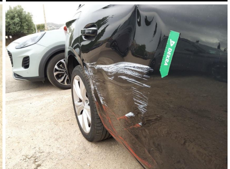
Puerta / Trasero Derecho / Abolladura
