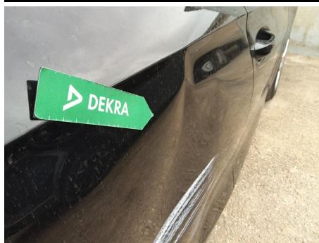
Puerta / Trasero Derecho / Abolladura
