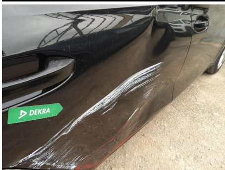
Puerta / Trasero Derecho / Abolladura
