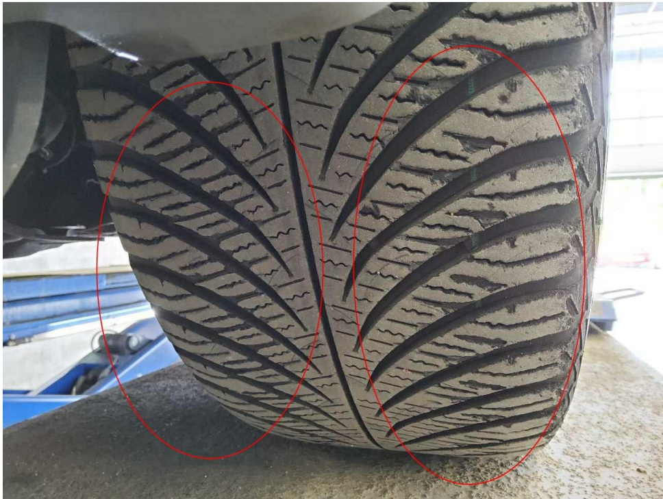
Bild 23 : Reifen vorne links, Auswaschung in der Lauffläche
