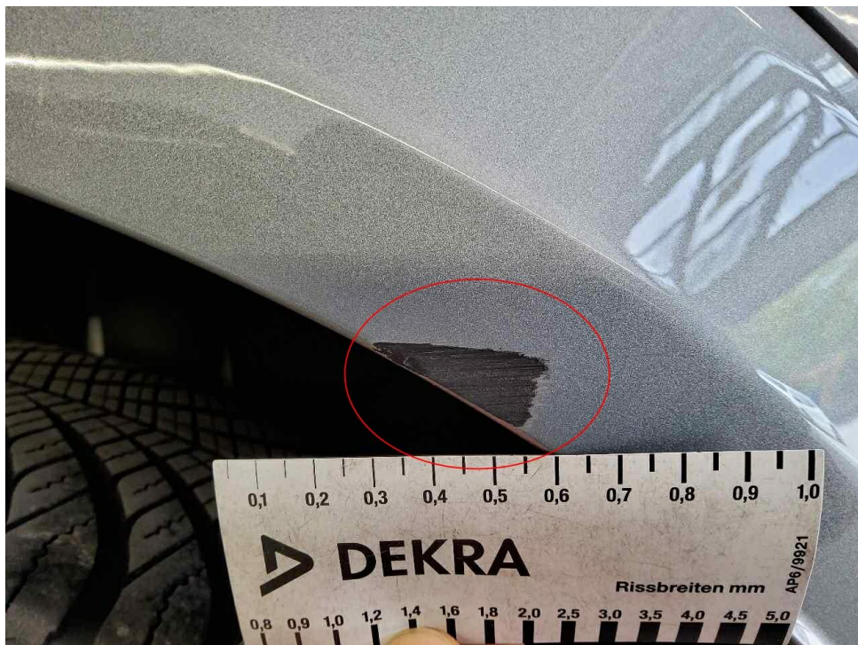
Bild 20 : Radlaufblende hinten links, verschrammt (Materialabtrag)
