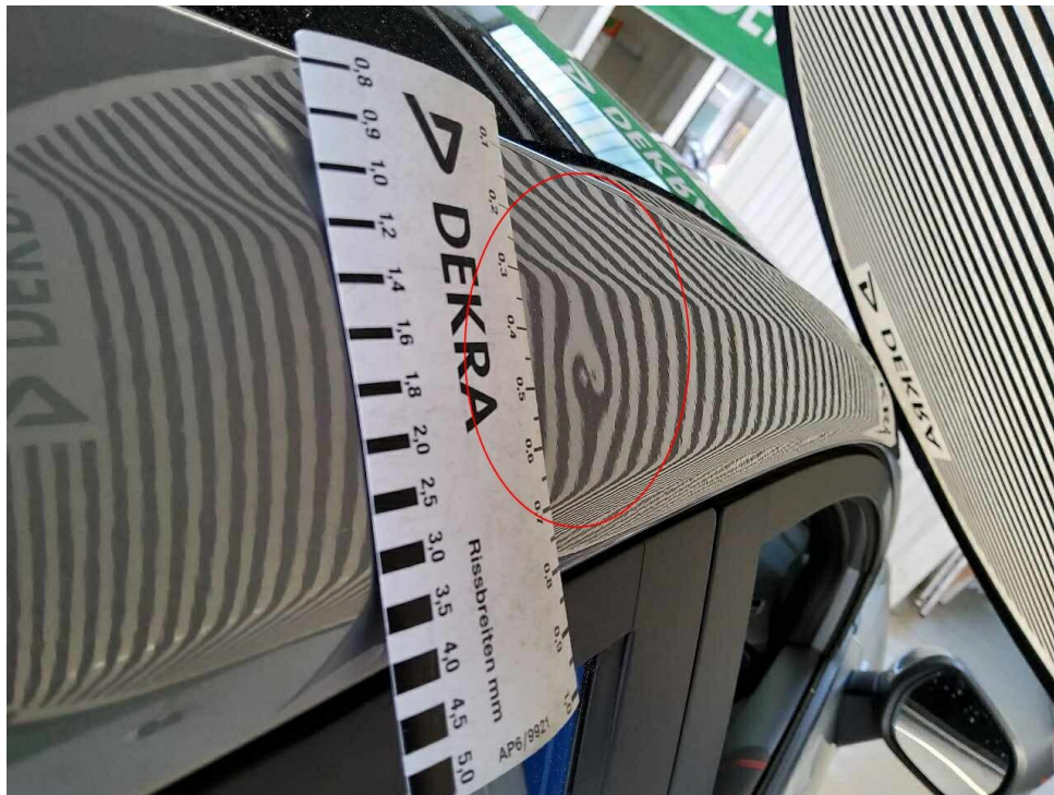
Bild 21 : Dachrahmen rechts, eingedellt
