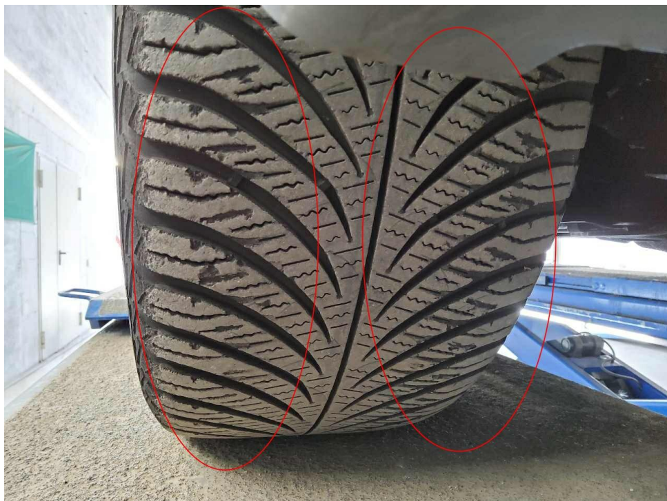
Bild 22 : Reifen vorne rechts, Auswaschung in der Lauffläche
