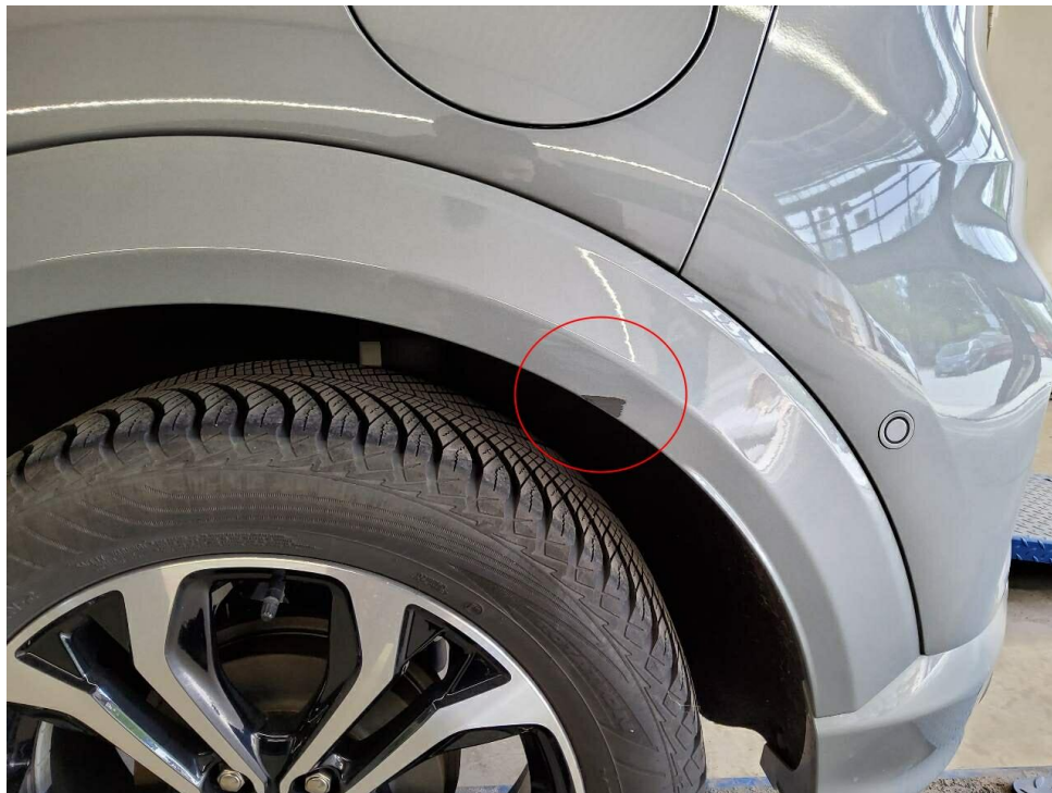
Bild 19 : Radlaufblende hinten links, verschrammt (Materialabtrag)
