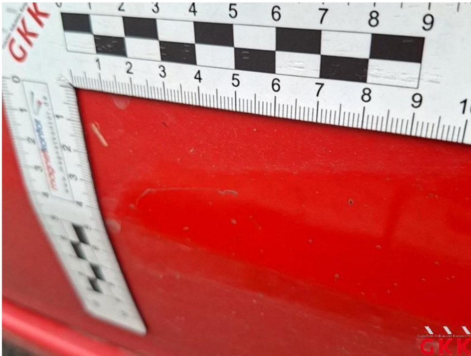
Bild 29. Tür vorne rechts, beschädigt, instand setzen - lackieren
