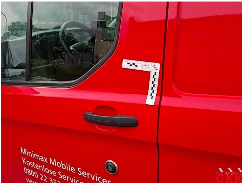
Bild 68. Tür vorne links, beschädigt, instand setzen - lackieren
