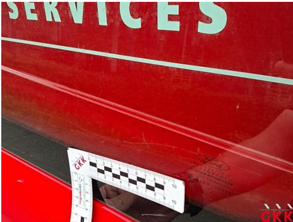
Bild 40. Schiebetür rechts, Scheibe, verkratzt, ersetzen
