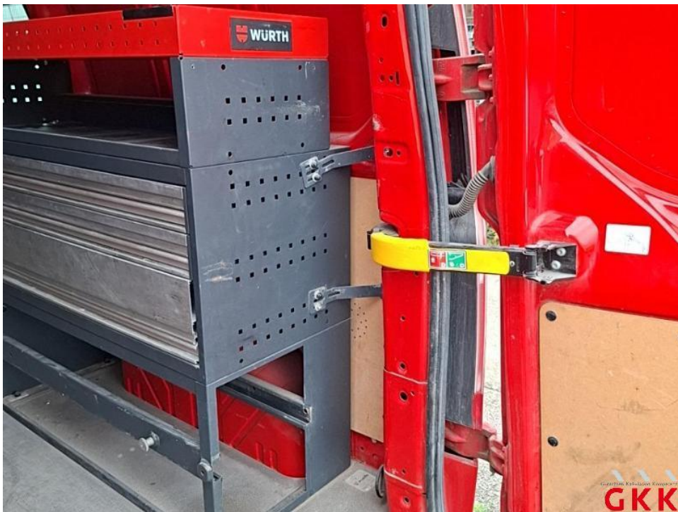
Bild 52. D-Säule rechts innen, beschädigt, instand setzen - lackieren
