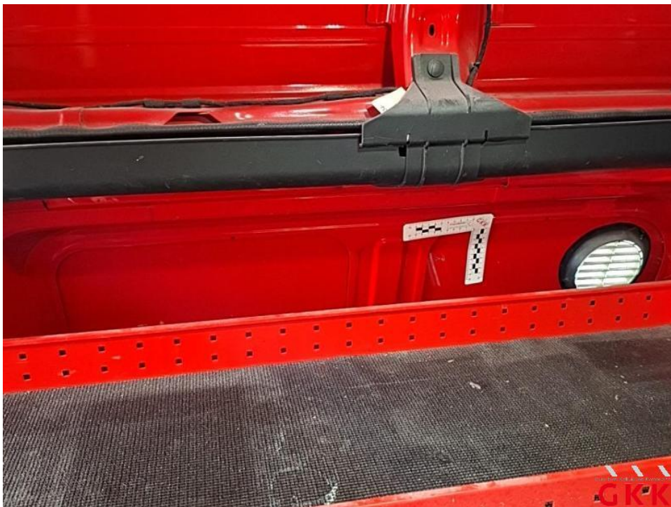
Bild 64. Seitenwand links, innen, verkratzt, Smartrepair
