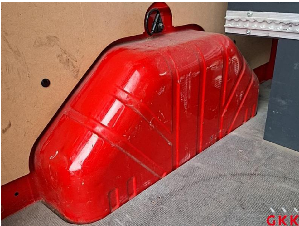
Bild 58. Radhaus hinten links, verkratzt, lackieren
