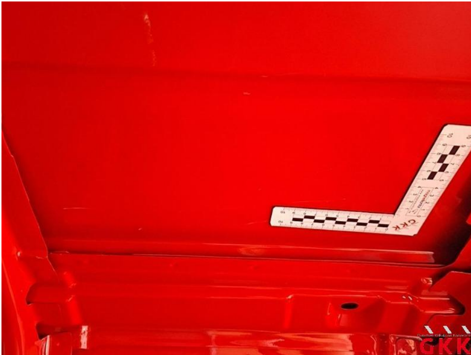
Bild 62. Dach, innen, verkratzt, Smartrepair
