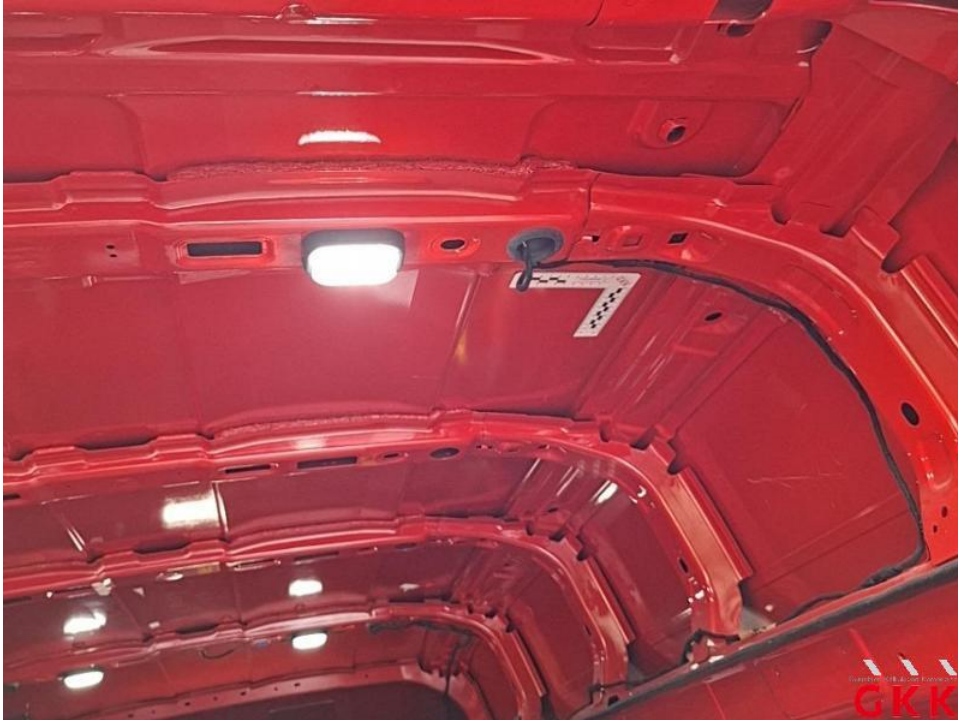
Bild 61. Dach, innen, verkratzt, Smartrepair
