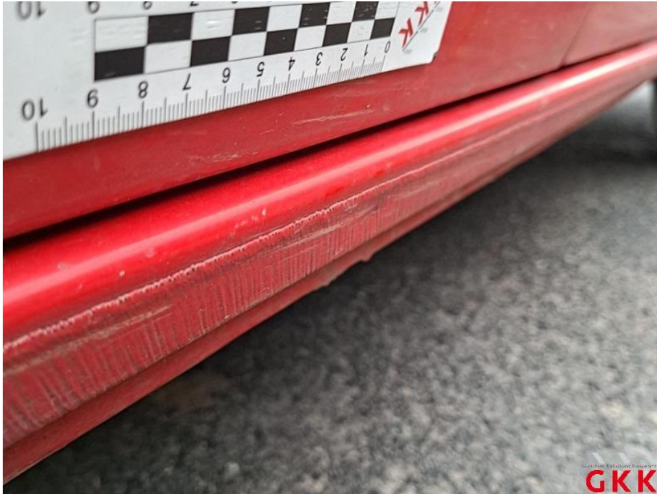
Bild 35. Schweller rechts, beschädigt, instand setzen - lackieren
