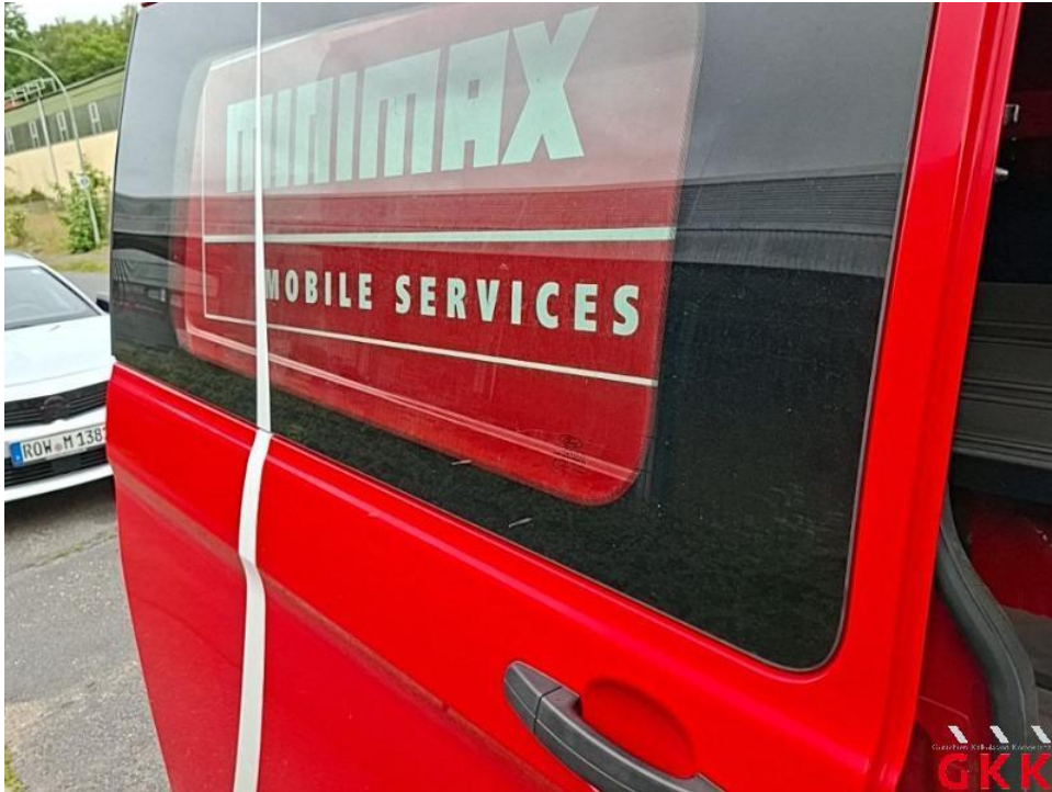
Bild 39. Schiebetür rechts, Scheibe, verkratzt, ersetzen
