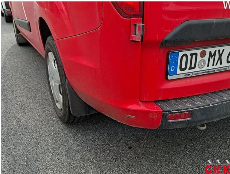
Bild 66. Stoßfänger hinten, Ecke links -lackiert-, beschädigt, ersetzen
