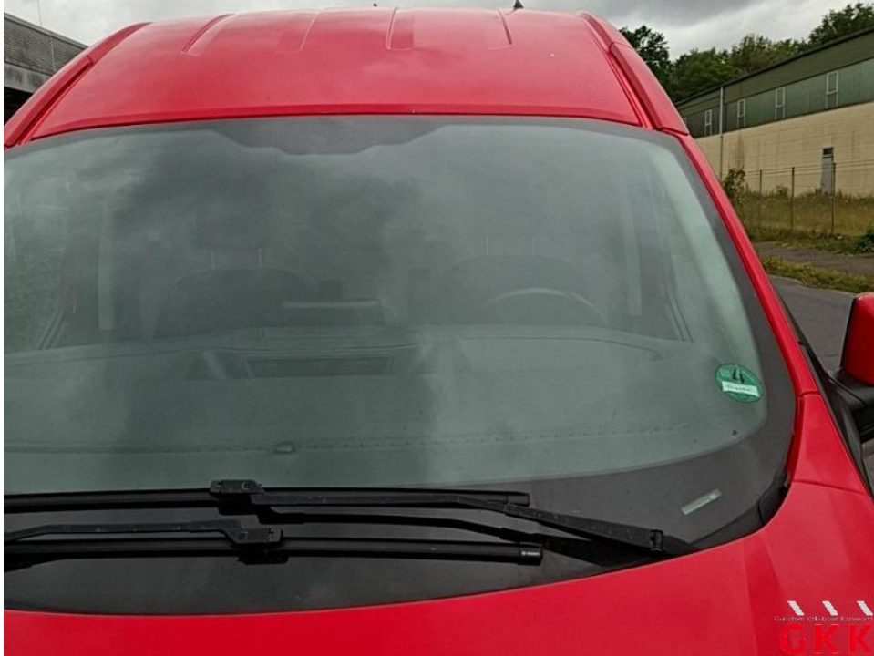
Bild 15. Frontscheibe, beheizt mit Regensensor und Frontkamera, Steinschlag mit Rissbildung, ersetzen
