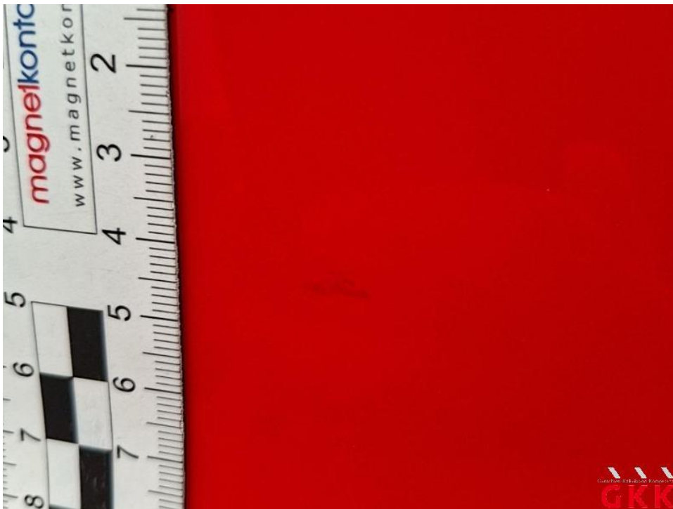
Bild 70. Tür vorne links, beschädigt, instand setzen - lackieren
