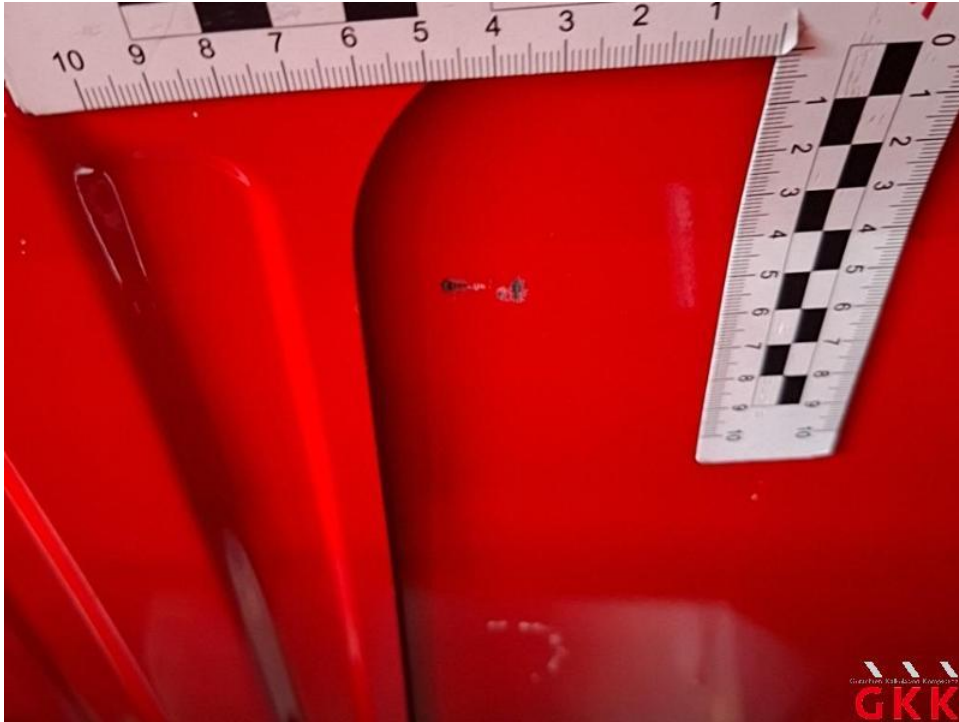
Bild 65. Seitenwand links, innen, verkratzt, Smartrepair
