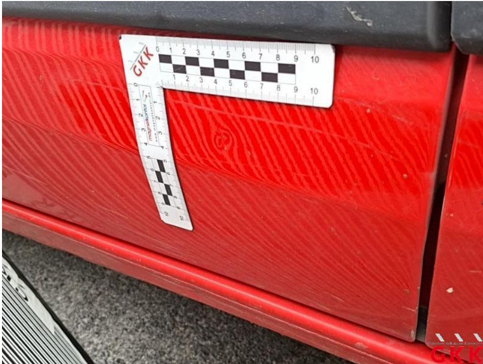
Bild 31. Schiebetür rechts, unterhalb, beschädigt, instand setzen - lackieren
