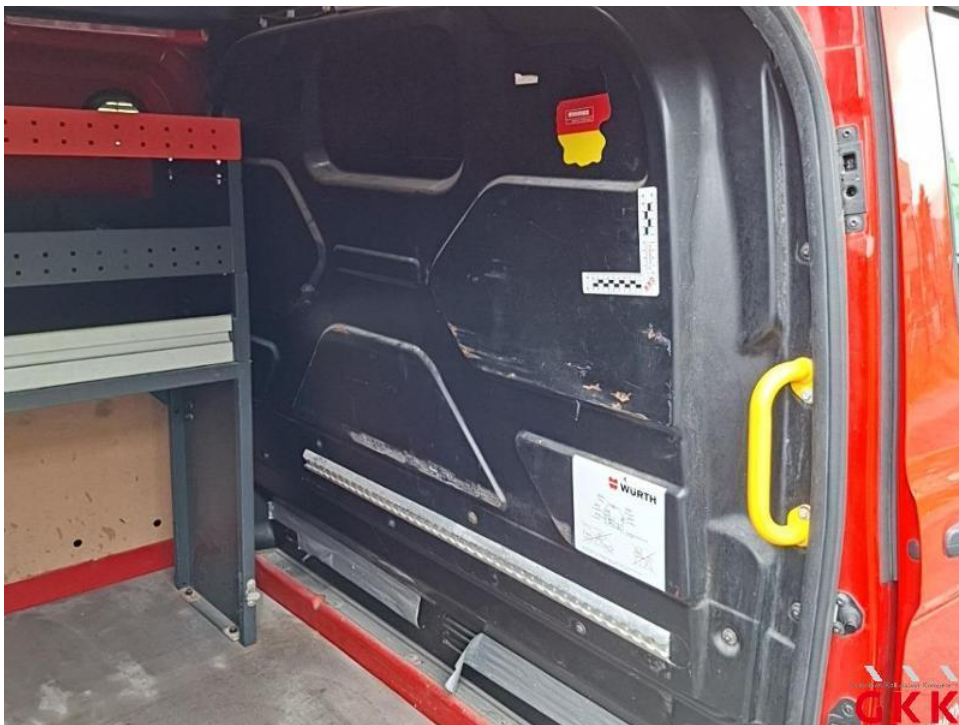
Bild 36. Trennwand, oberhalb, beschädigt, ersetzen
