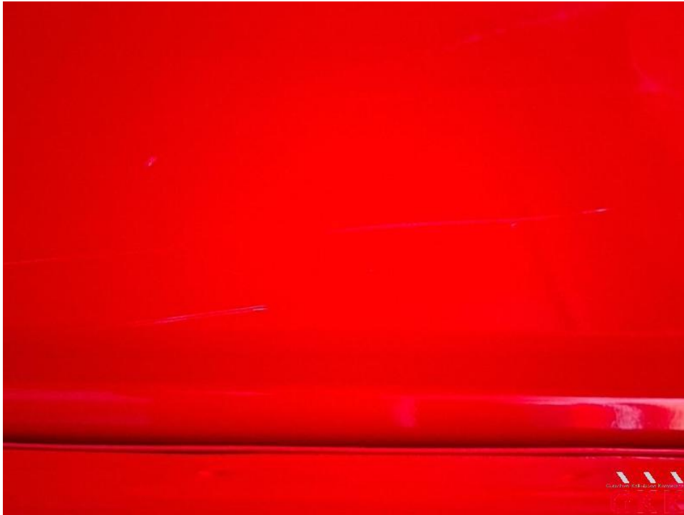
Bild 63. Dach, innen, verkratzt, Smartrepair
