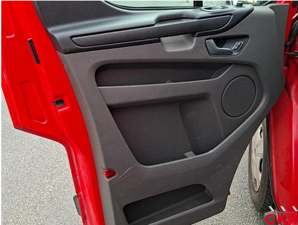
Bild 71. Tür vorne links, Innenverkleidung -Standard-, verkratzt, ersetzen
