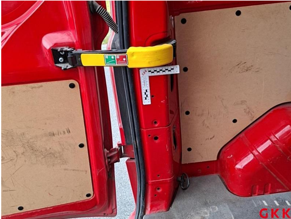
Bild 55. D-Säule links innen, beschädigt, instand setzen - lackieren
