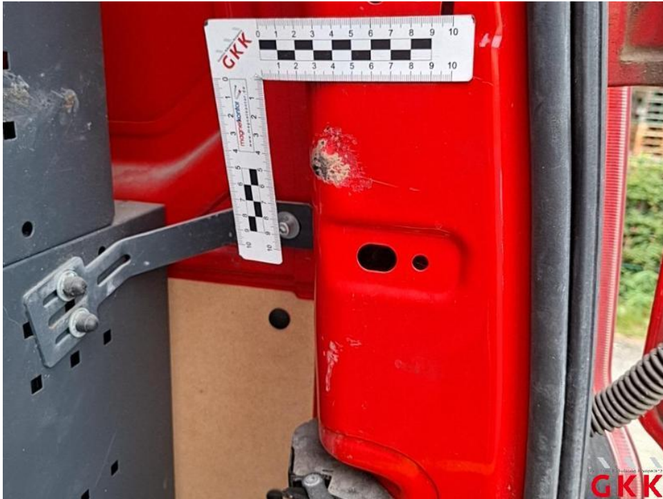
Bild 53. D-Säule rechts innen, beschädigt, instand setzen - lackieren
