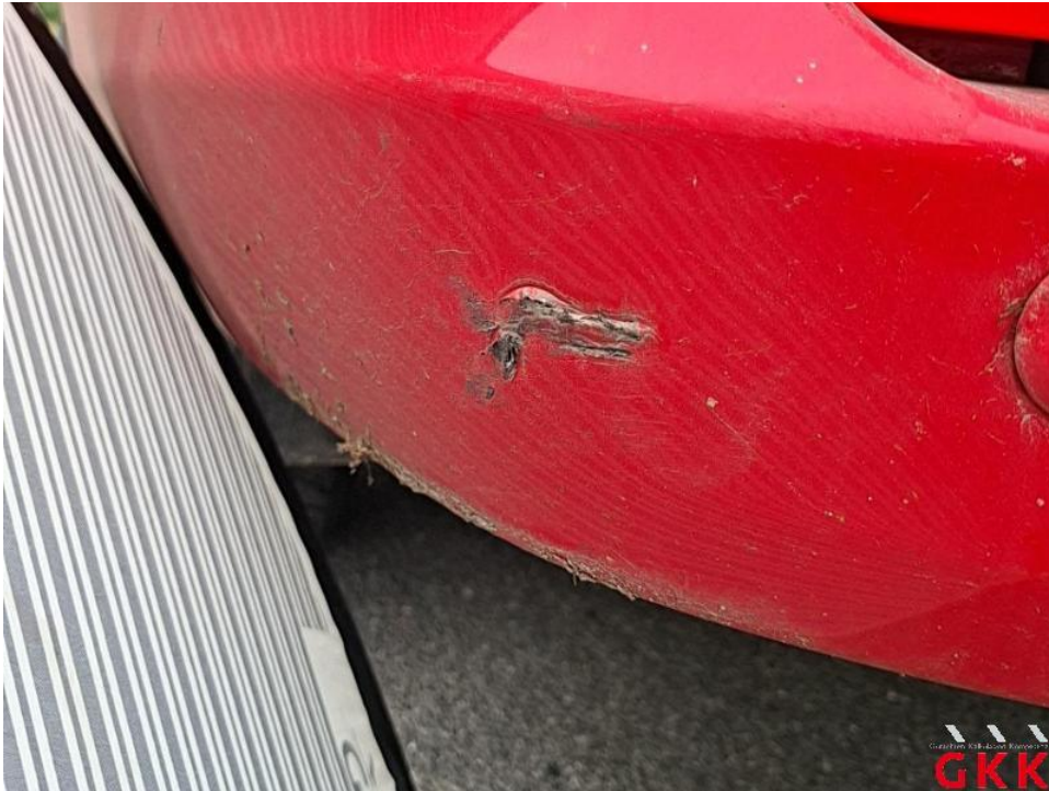
Bild 67. Stoßfänger hinten, Ecke links -lackiert-, beschädigt, ersetzen
