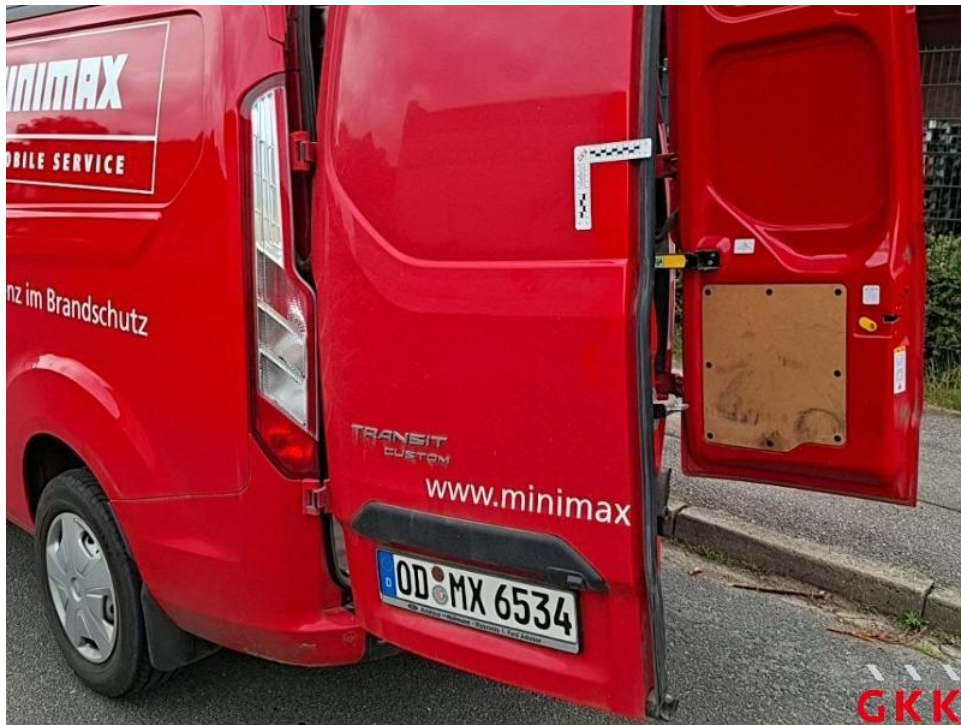
Bild 49. Hecktür links, beschädigt, instand setzen - lackieren
