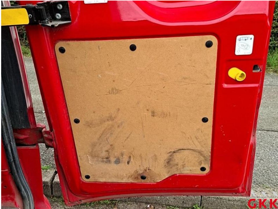
Bild 47. Hecktür rechts, Innenverkleidung, beschädigt, ersetzen
