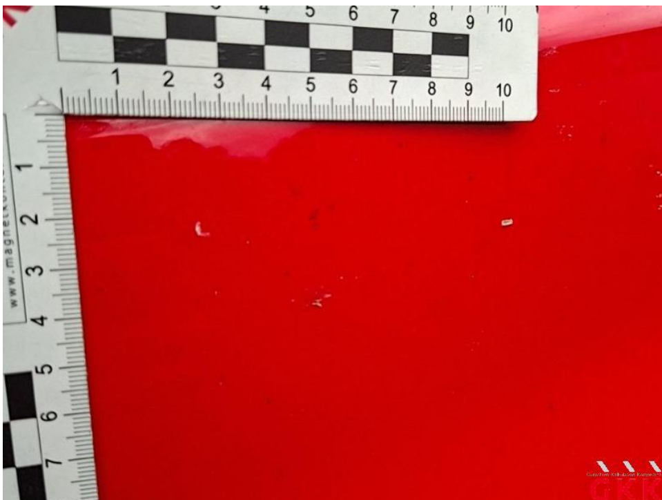
Bild 18. vorn links Stoßfänger vorne, Verkleidung -lackiert-, Steinschlag und Kratzer, auslegen, schleifen, polieren
