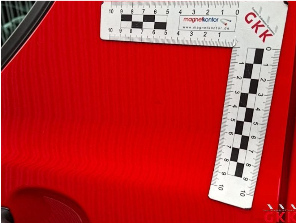
Bild 69. Tür vorne links, beschädigt, instand setzen - lackieren
