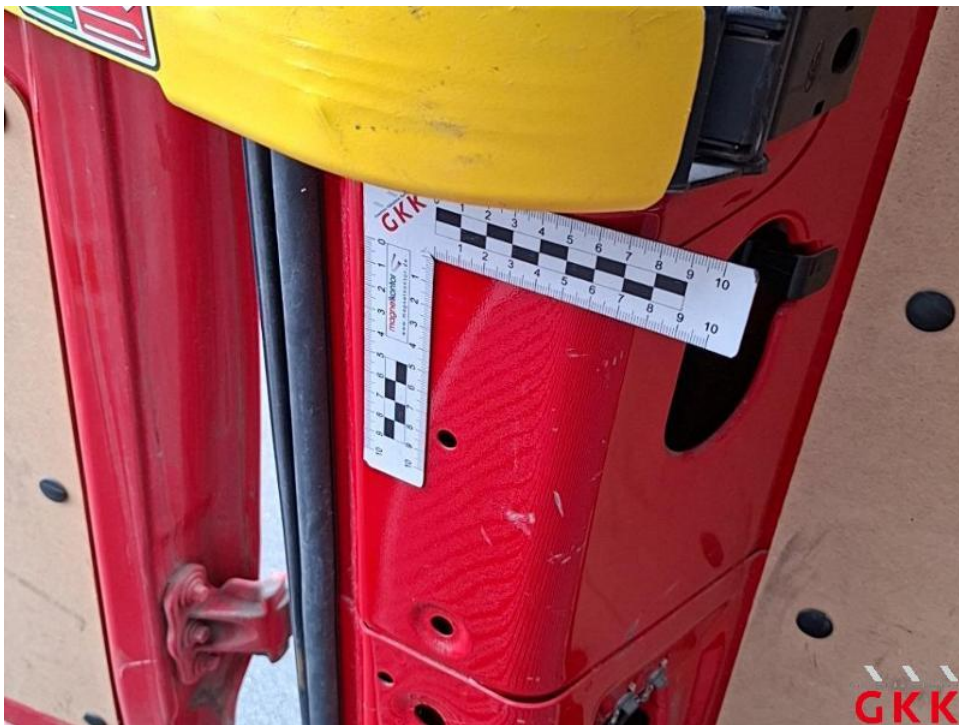
Bild 56. D-Säule links innen, beschädigt, instand setzen - lackieren
