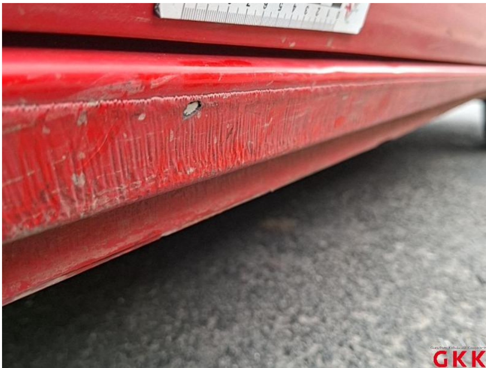
Bild 34. Schweller rechts, beschädigt, instand setzen - lackieren
