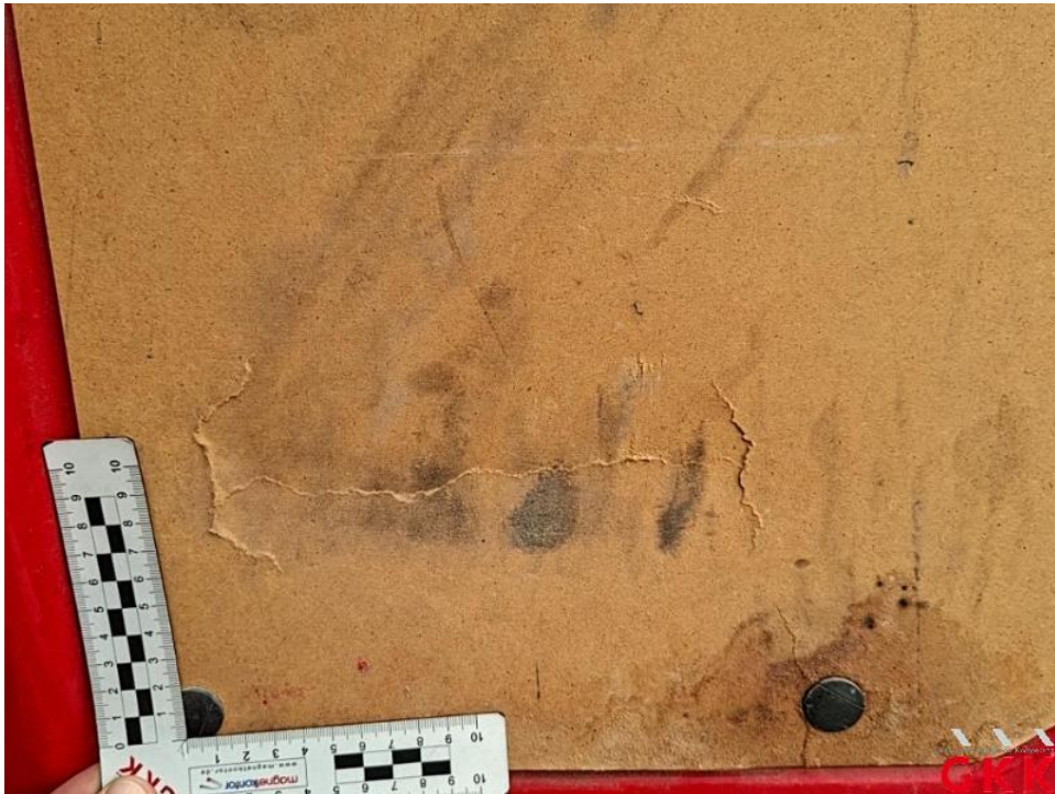
Bild 48. Hecktür rechts, Innenverkleidung, beschädigt, ersetzen
