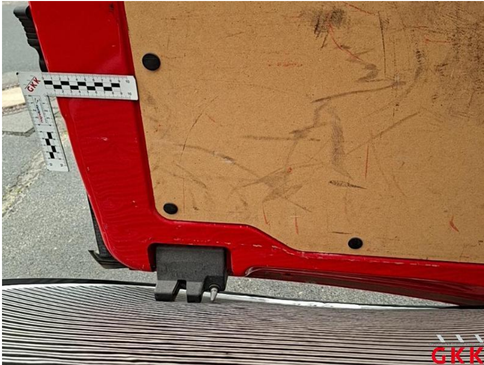
Bild 51. Hecktür links, beschädigt, instand setzen - lackieren
