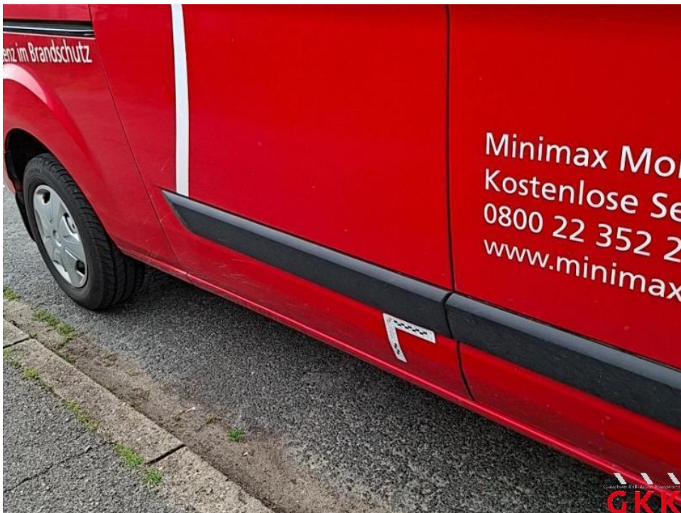
Bild 30. Schiebetür rechts, unterhalb, beschädigt, instand setzen - lackieren
