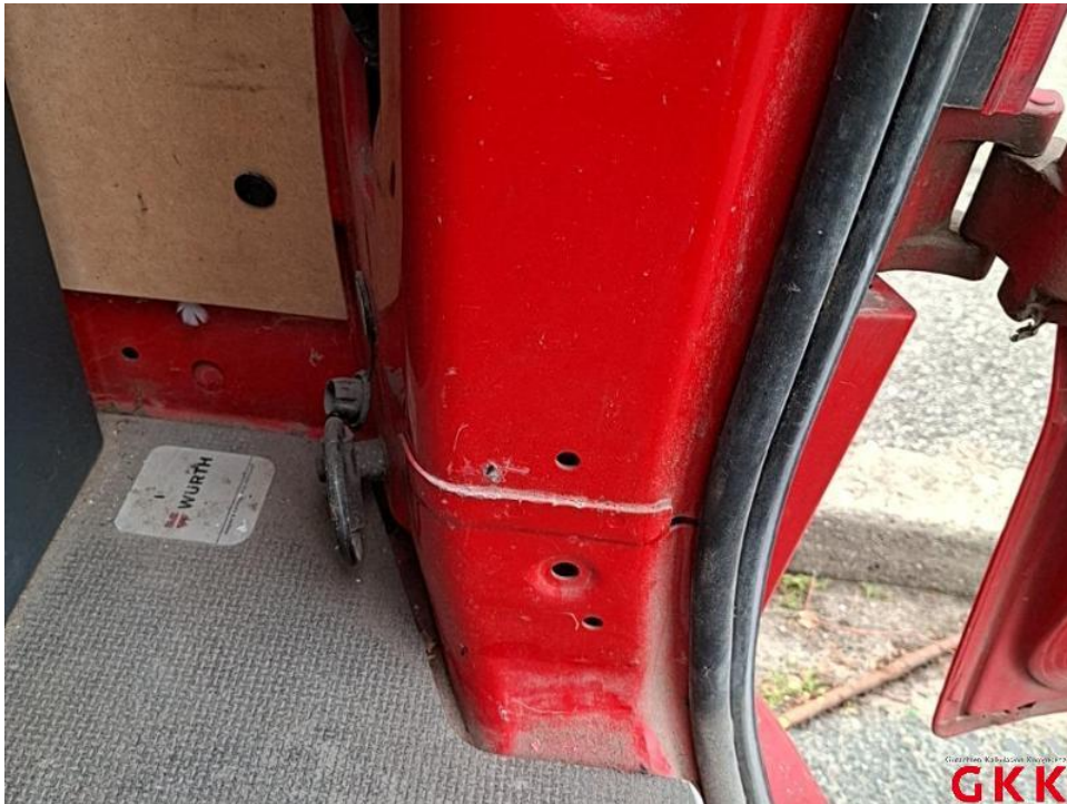
Bild 54. D-Säule rechts innen, beschädigt, instand setzen - lackieren
