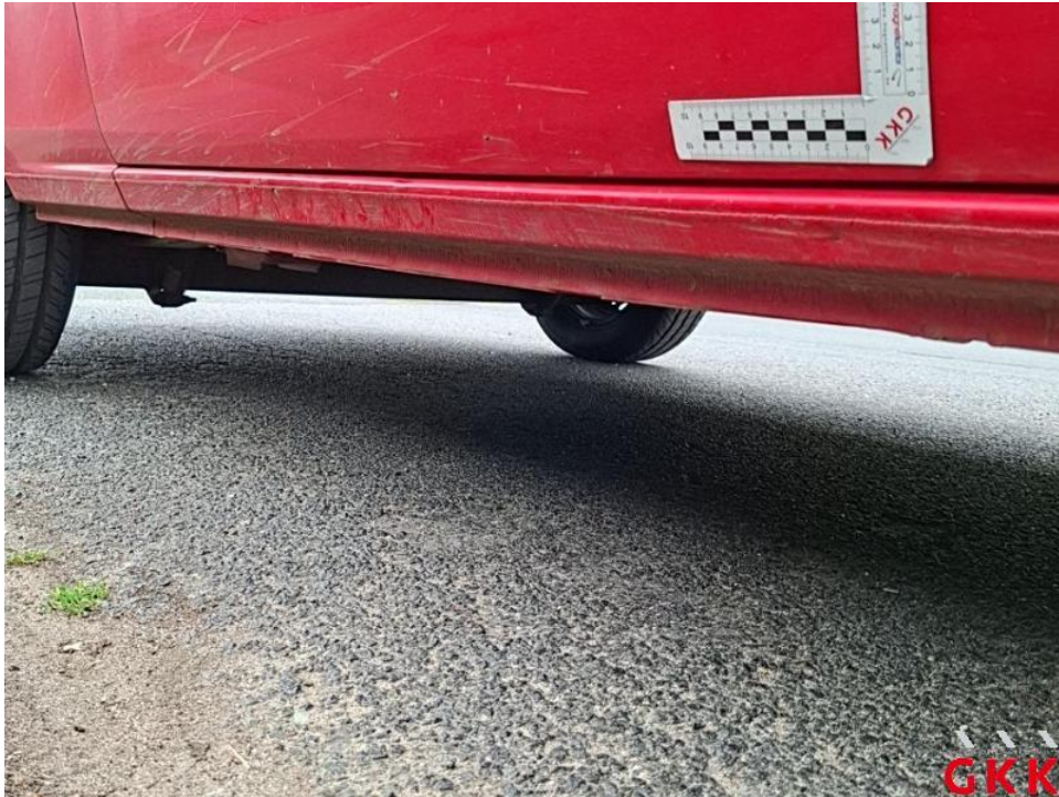
Bild 33. Schweller rechts, beschädigt, instand setzen - lackieren
