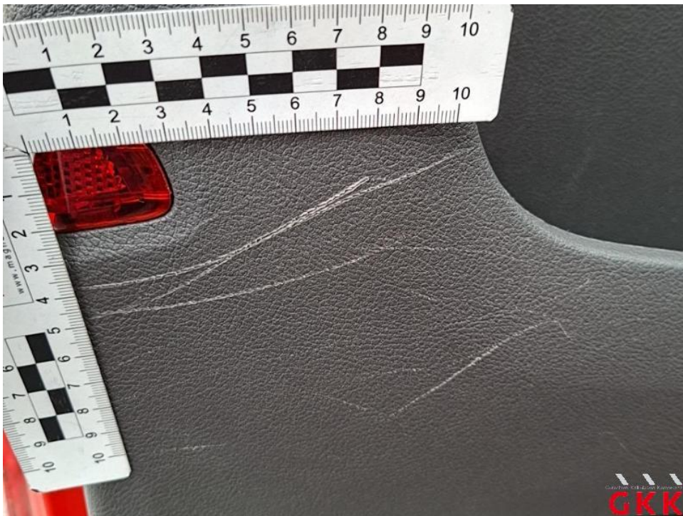
Bild 72. Tür vorne links, Innenverkleidung -Standard-, verkratzt, ersetzen
