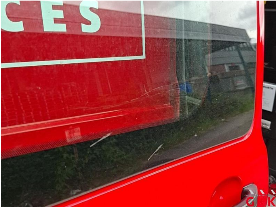
Bild 41. Schiebetür rechts, Scheibe, verkratzt, ersetzen
