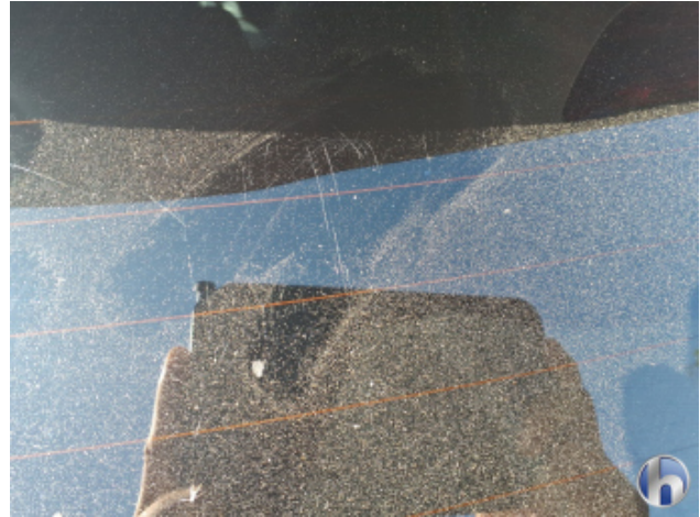
18. Fenster Außen hinten Kratzer - Erneuern
