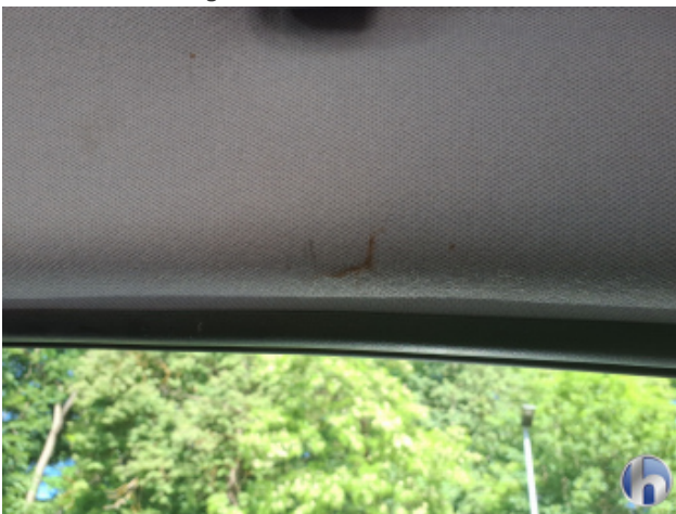
16. Dachhimmel Verschmutzt - Reinigen
