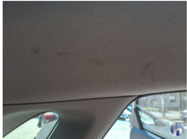
16. Dachhimmel Verschmutzt - Reinigen
