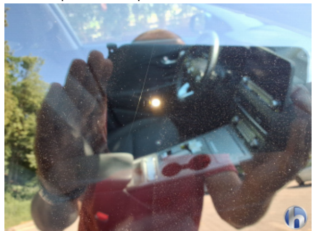
8. Seitenscheibe - Vorne - Rechts Kratzer - Erneuern
