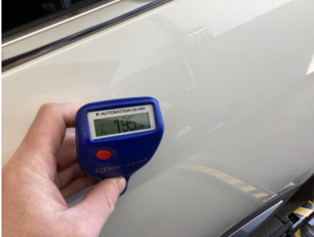
Reparierter Schaden Tür HL
