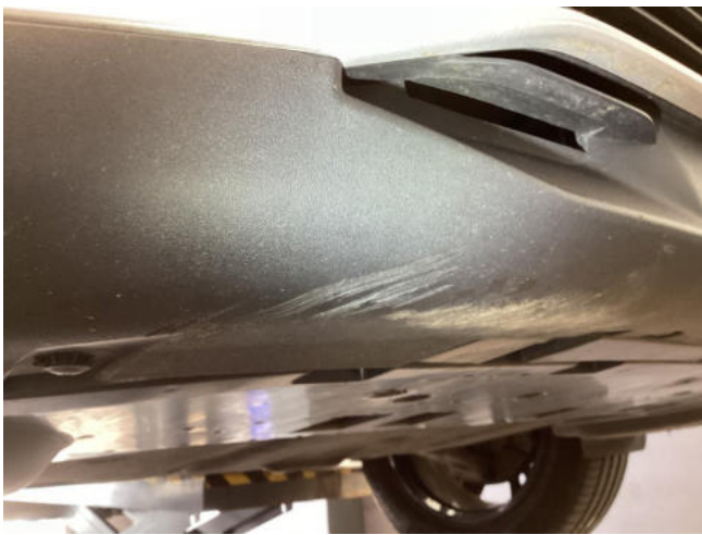
Stoßfängerspoiler V Abrieb - erneuern
