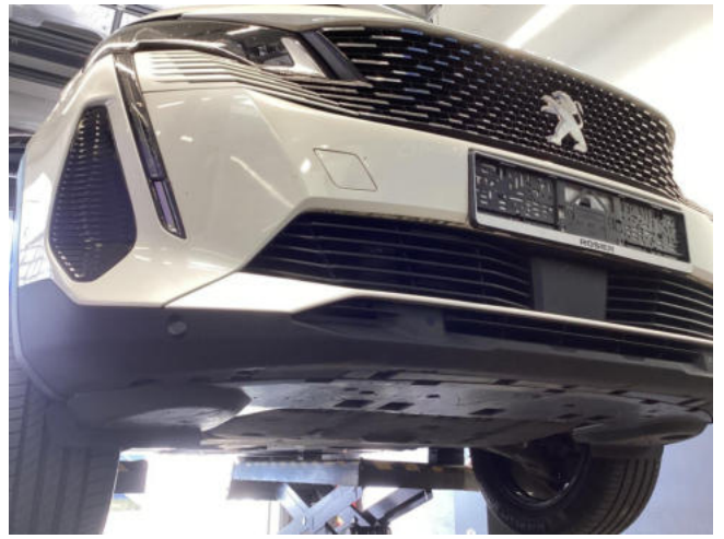
Stoßfängerspoiler V Abrieb - erneuern
