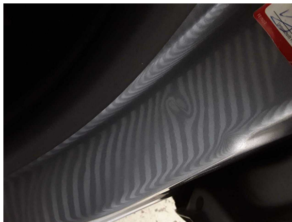
Beschädigung #2: Schweller links: Einstieg - Delle(n) - sanft instandsetzen
