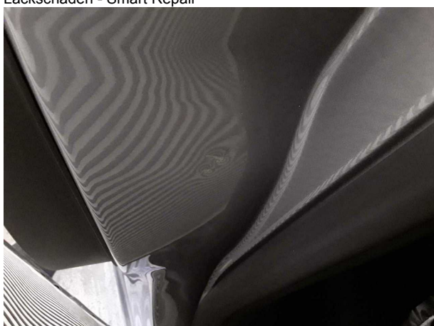
Beschädigung #3: Seitenwand rechts: Einstieg - Delle / Lackschaden - Smart Repair
