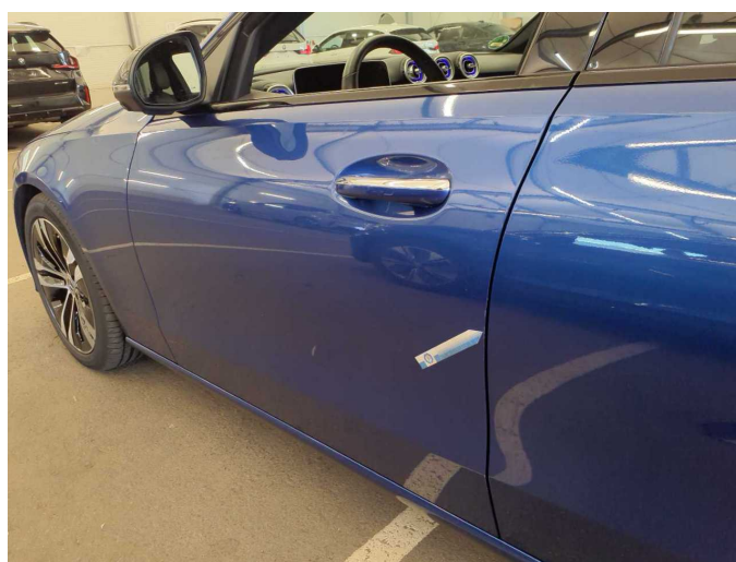
Damage 2: Door - front left side: Door edge - Scratch(es) - Smart repair
