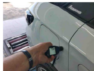
Lackstärke Seitenwand hinten rechts
