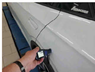
Lackstärke Seitenwand hinten links
