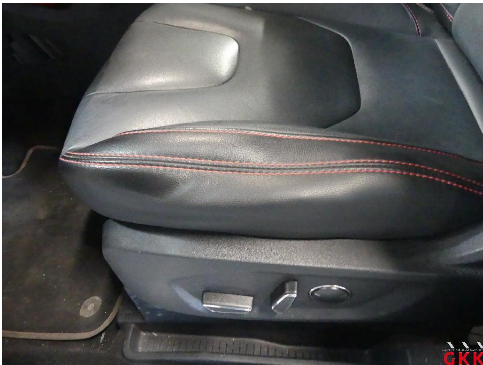
Bild 28 Sitz vorne links, Polster Sitzkissen, beschädigt, ersetzen
