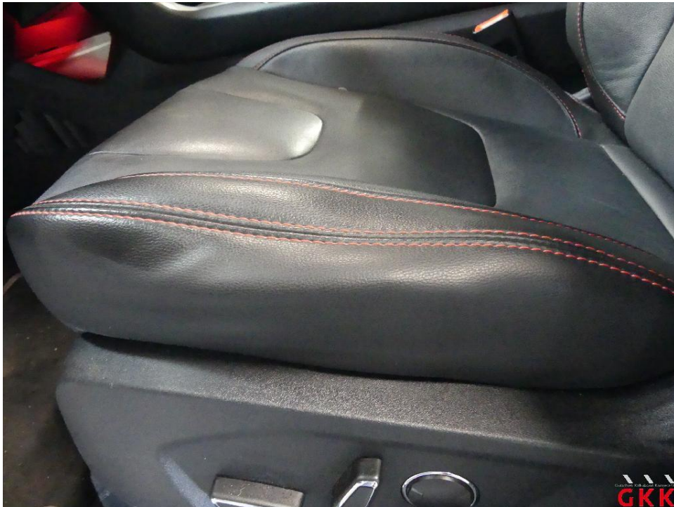
Bild 29 Sitz vorne links, Polster Sitzkissen, beschädigt, ersetzen
