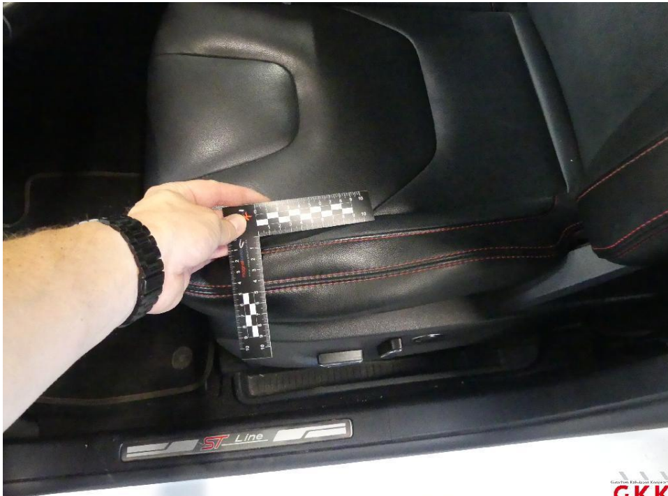
Bild 27 Sitz vorne links, Polster Sitzkissen, beschädigt, ersetzen
