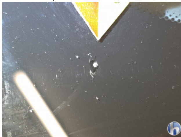
5. Windschutzscheibe Riss - Erneuern
