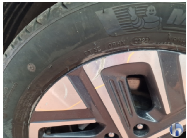
2. Felge Hinten - Rechts Beschädigt - Smart Repair
