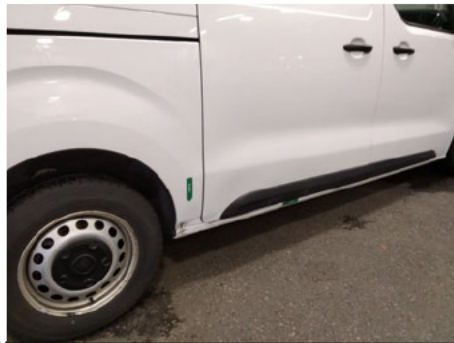
Seitenwand / Hinten Rechts / Delle
