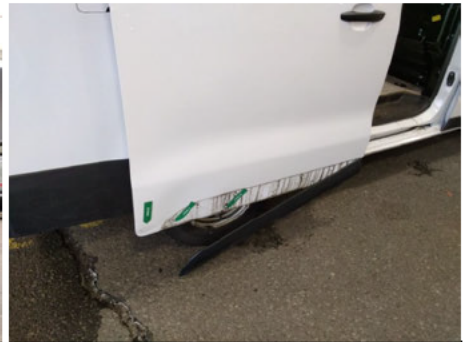
Tür / Rechts / Delle
