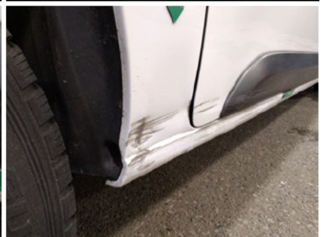
Seitenwand / Hinten Rechts / Delle
