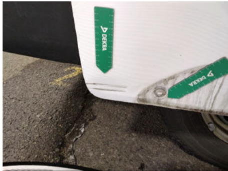
Tür / Rechts / Delle
