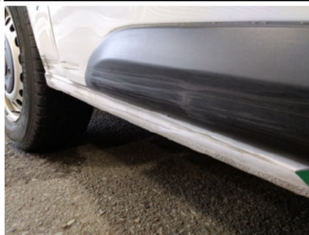
Seitenwand / Hinten Rechts / Delle
