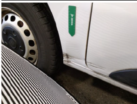
Seitenwand / Hinten Rechts / Delle
