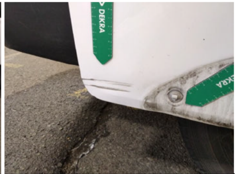
Tür / Rechts / Delle
