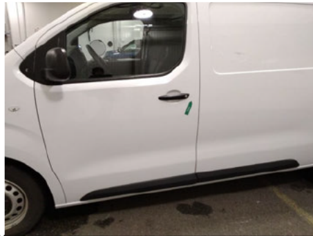
Tür / Vorne Links / Delle
