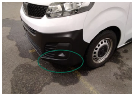
Stoßfänger unterhalb / Vorne / Kratzer
