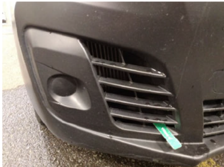
Ladeluftkühler / Vorne Rechts / Delle
