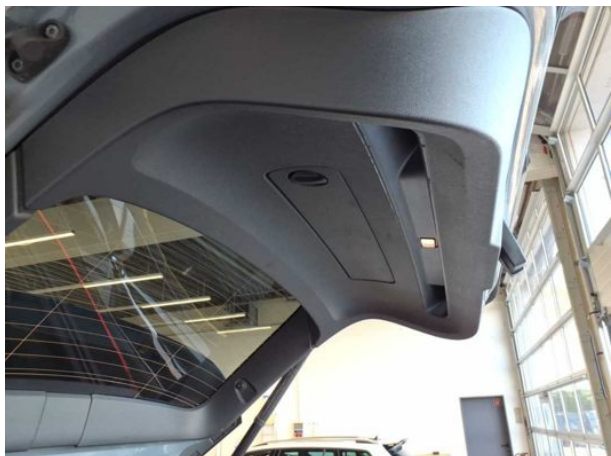
Beschädigung #1: Verkleidungen/Abdeckungen: Heckdeckel, Innenverkleidung - Kratzer - Wertminderung
