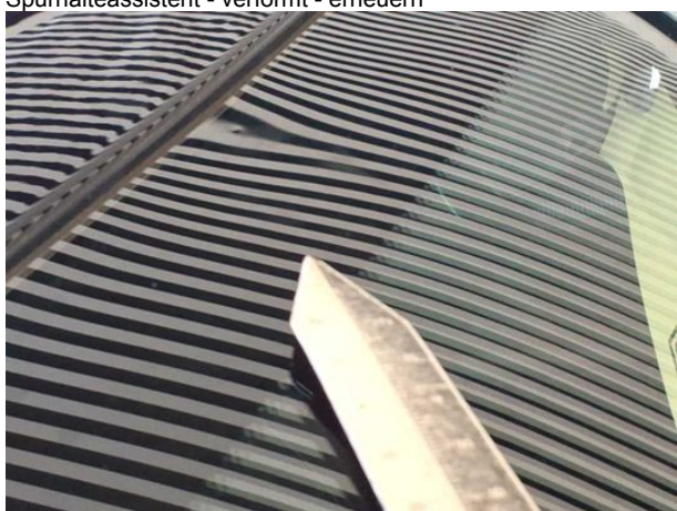
Beschädigung #10: Verglasung: Frontscheibe mit Spurhalteassistent - verformt - erneuern
