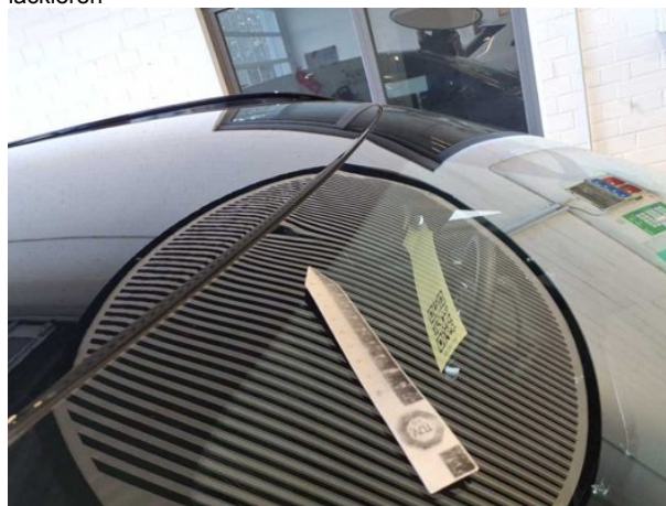
Beschädigung #10: Verglasung: Frontscheibe mit Spurhalteassistent - verformt - erneuern
