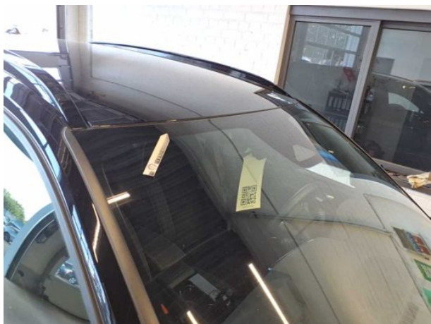
Beschädigung #10: Verglasung: Frontscheibe mit Spurhalteassistent - verformt - erneuern
