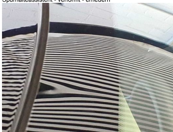
Beschädigung #10: Verglasung: Frontscheibe mit Spurhalteassistent - verformt - erneuern
