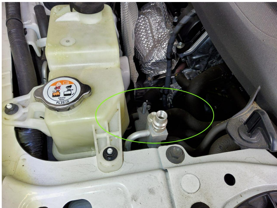
Bild 8 : Abdeckung Anschlüsse Klimaanlage fehlen
