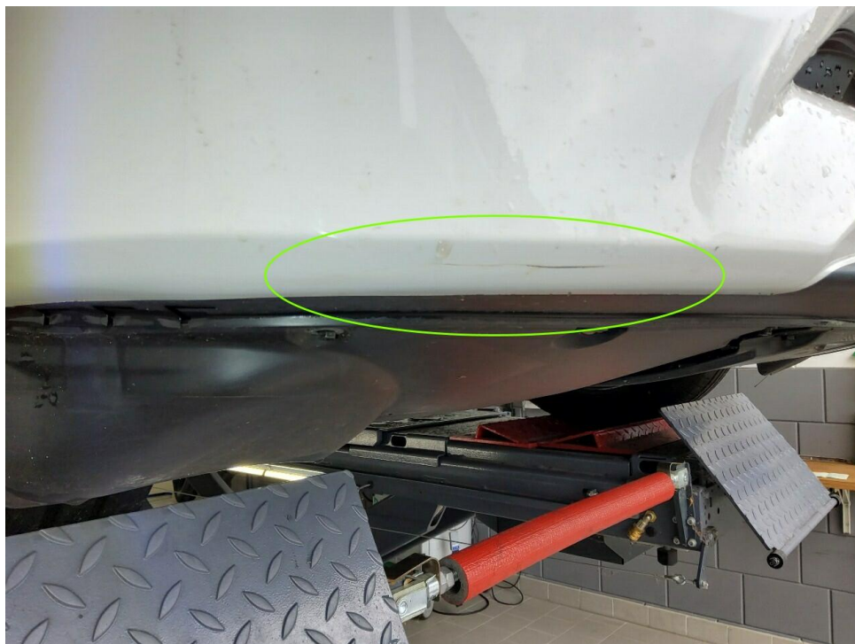
Bild 10 : Stoßfänger vorne unterhalb rechts verschrammt
