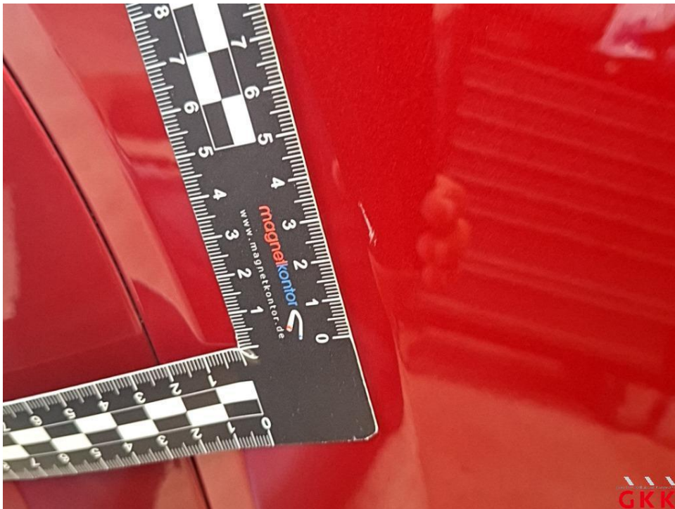
Bild 14. Tür hinten rechts, verkratzt, auslegen, schleifen, polieren
