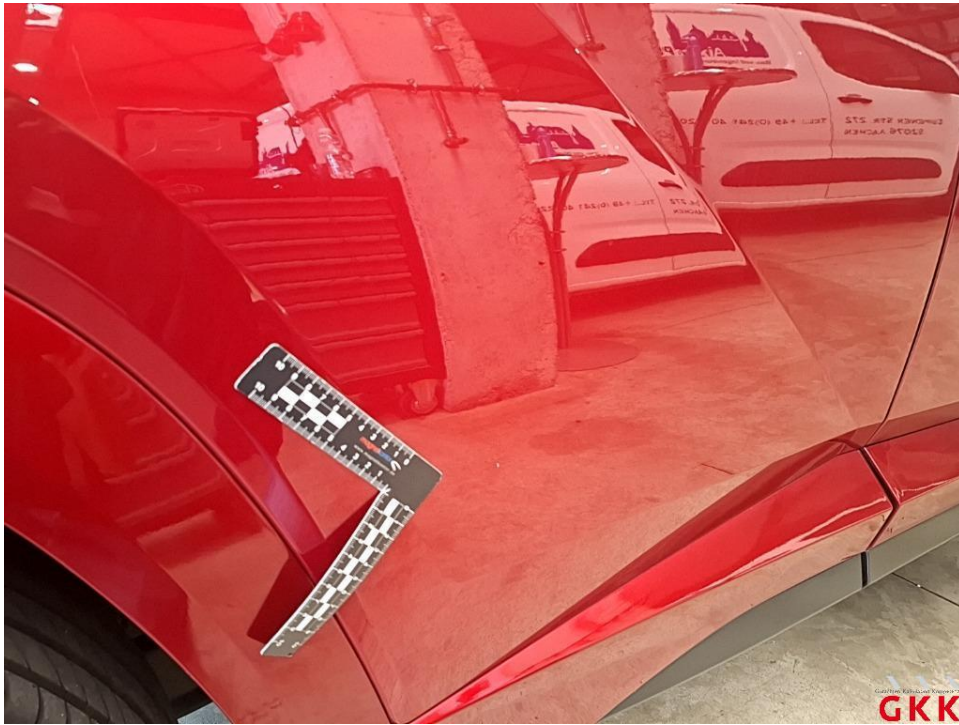
Bild 13. Tür hinten rechts, verkratzt, auslegen, schleifen, polieren
