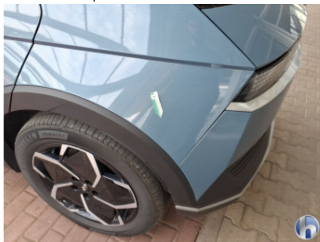
5. Seitenwand - Hinten - Links Kratzer - Smart Repair
