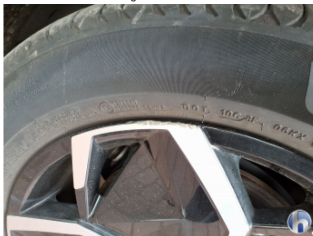
2. Felge Hinten - Rechts Beschädigt - Erneuern
