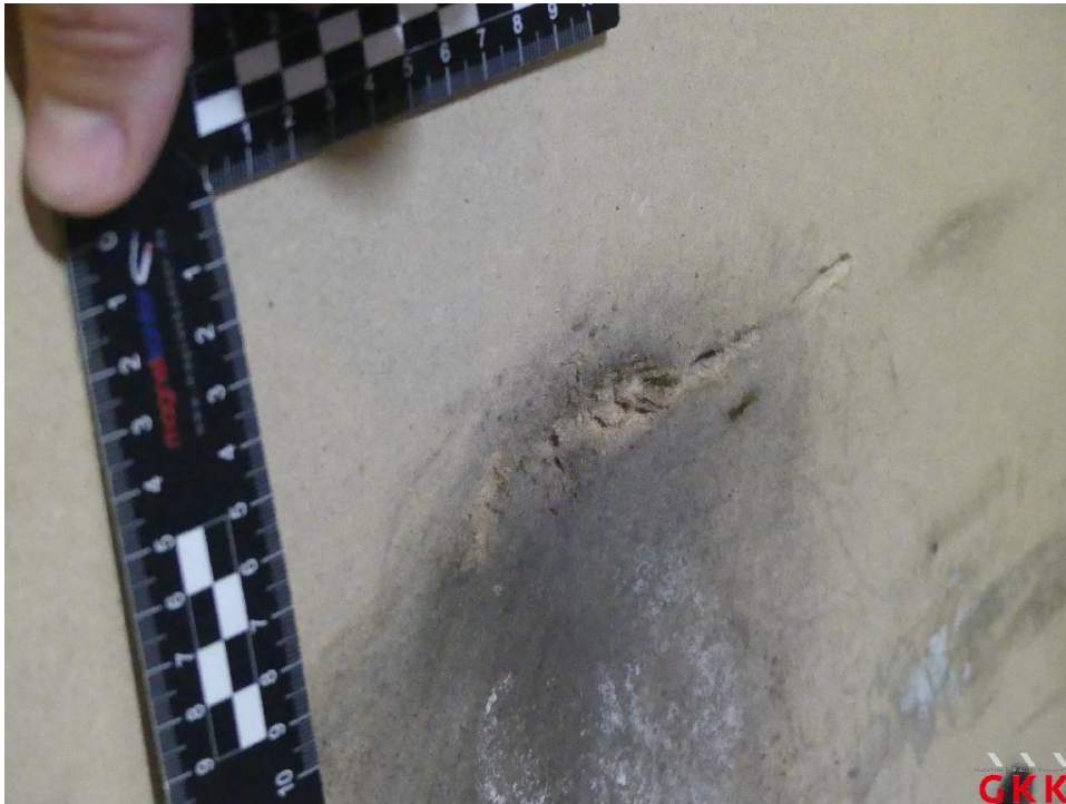
Bild 15 Schiebetür rechts, Innenverkleidung -Abdeckung-, beschädigt, ersetzen
