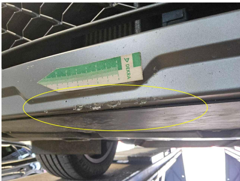
Bild 28 : Stoßfänger vorne, Spoilern verschrammt
