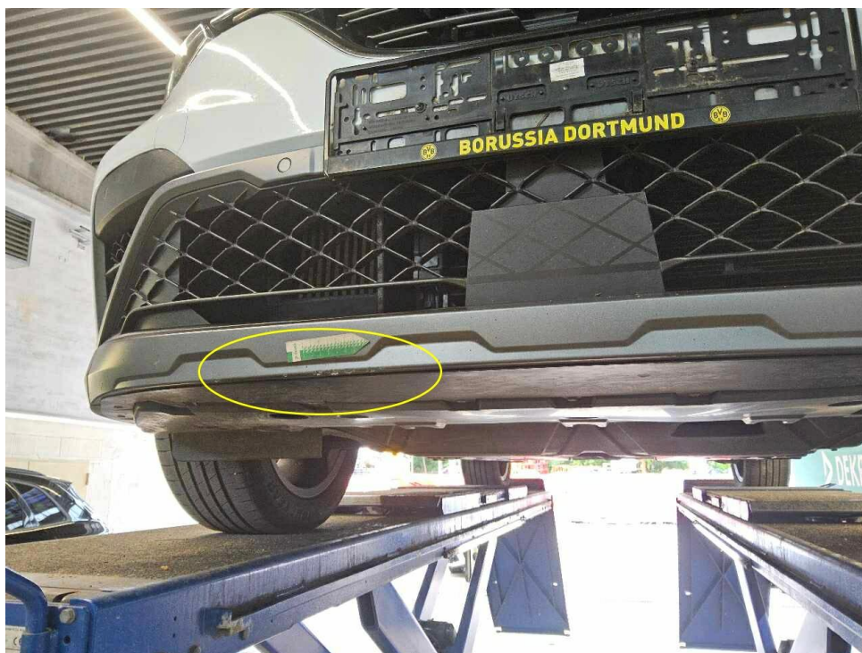
Bild 27 : Stoßfänger vorne, Spoilern verschrammt
