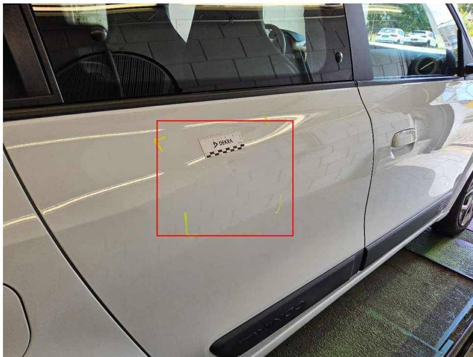
Bild 17 : Tür hinten rechts eingedellt
