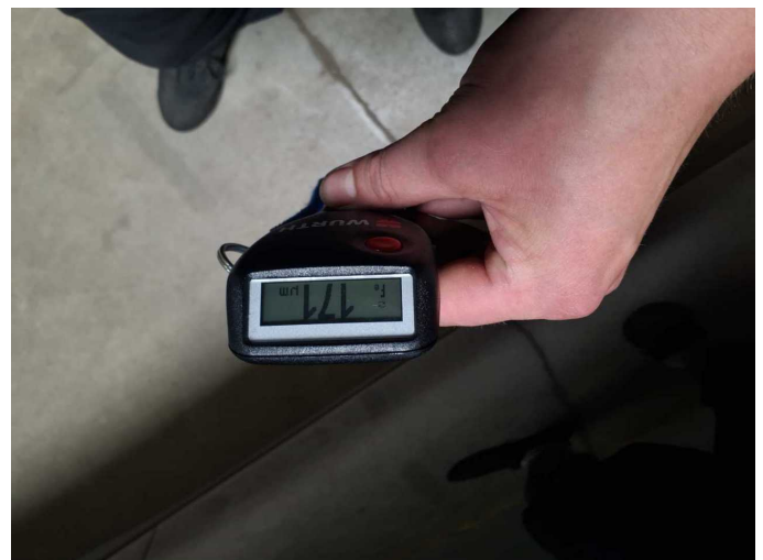
Door - front left side: 171 µm
