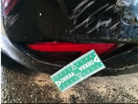
Antibrouillard / Arrière Gauche / Cassé
