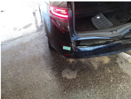
Pare-chocs / Arrière / Enfoncement
