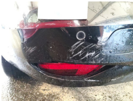
Pare-chocs / Arrière / Enfoncement
