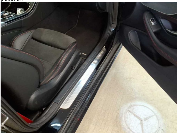
Beschädigung #6: Tür vorn rechts: Zierleiste unten - Delle(n) - erneuern
