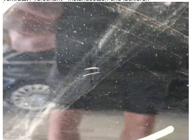
Beschädigung #17: Seitenwand rechts: Seitenwand - Kratze... instandsetzen und lackieren
