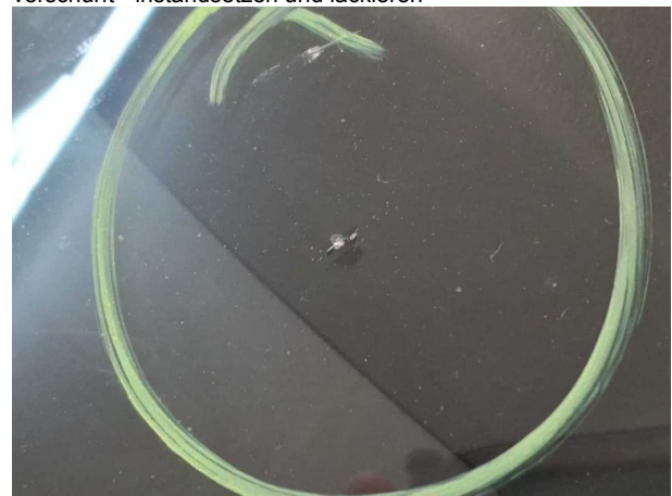
Beschädigung #15: Verglasung: Frontscheibe - Steinschlag - erneuern
