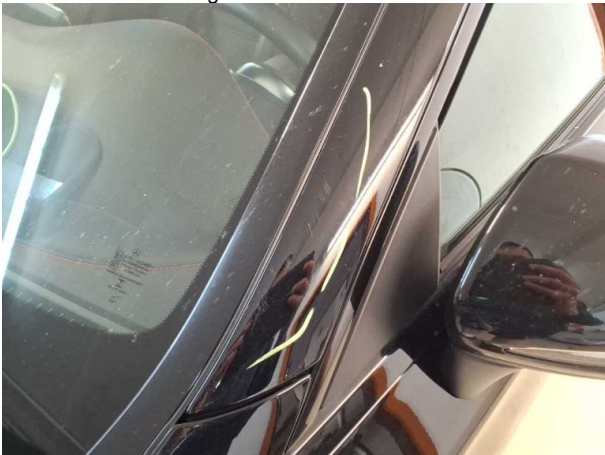
Beschädigung #4: Karosserie: A-Säule links - Kratzer - auslegen / polieren
