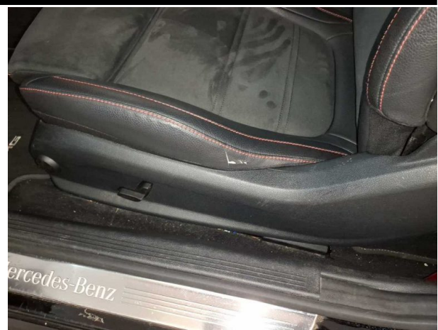
Beschädigung #13: Sitz vorn: Sitzbezug links - beschädigt - erneuern
