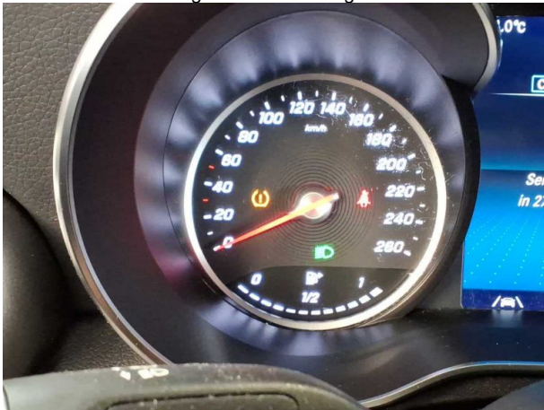
Beschädigung #8: Instrumententafel: Kontrollleuchte (RDKS brennt) - Befund festlegen - Diagnose durchführen
