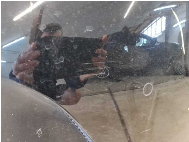
Beschädigung #16: Stossfänger hinten: Stossfänger hinten - verkratzt / verschürft - instandsetzen und lackieren
