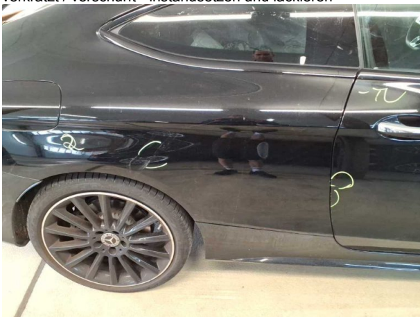
Beschädigung #17: Seitenwand rechts: Seitenwand - Kratzer - instandsetzen und lackieren
