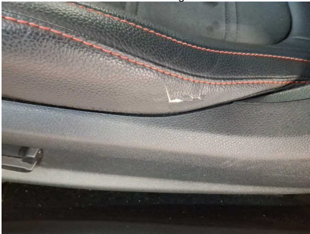
Beschädigung #13: Sitz vorn: Sitzbezug links - beschädigt - erneuern
