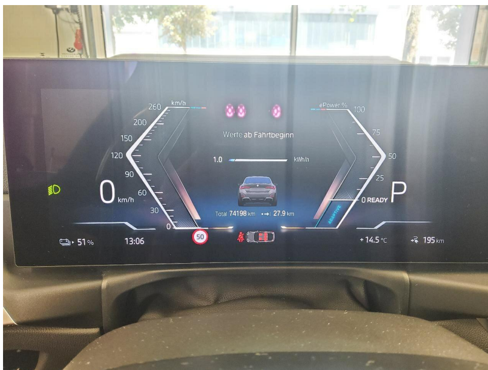
Bild 6 : Kombiinstrument (betriebsbereit) mit Km-Stand
