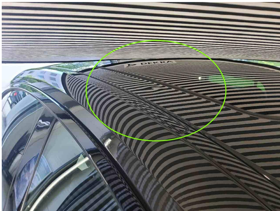
Bild 23 : Dach, mehrfach eingedellt
