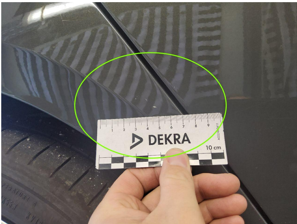
Bild 32 : Seitenteil rechts, Steinschläge
