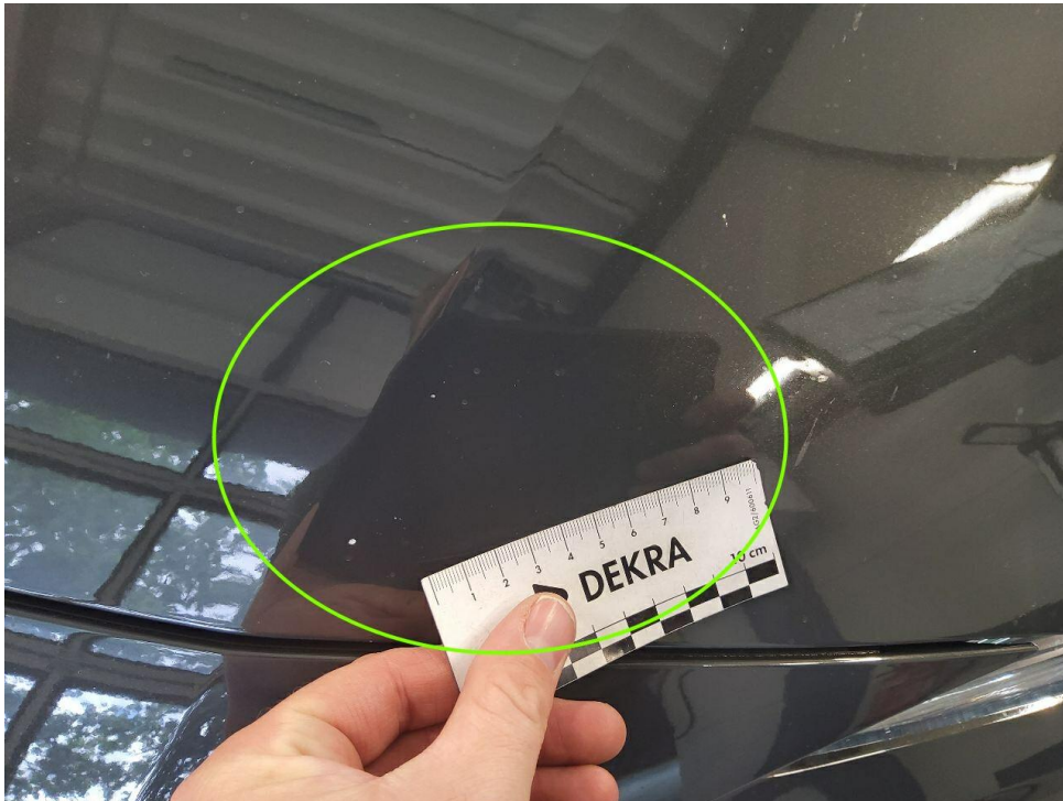
Bild 21 : Motorhaube, eingedellt, vereinzelte Steinschläge
