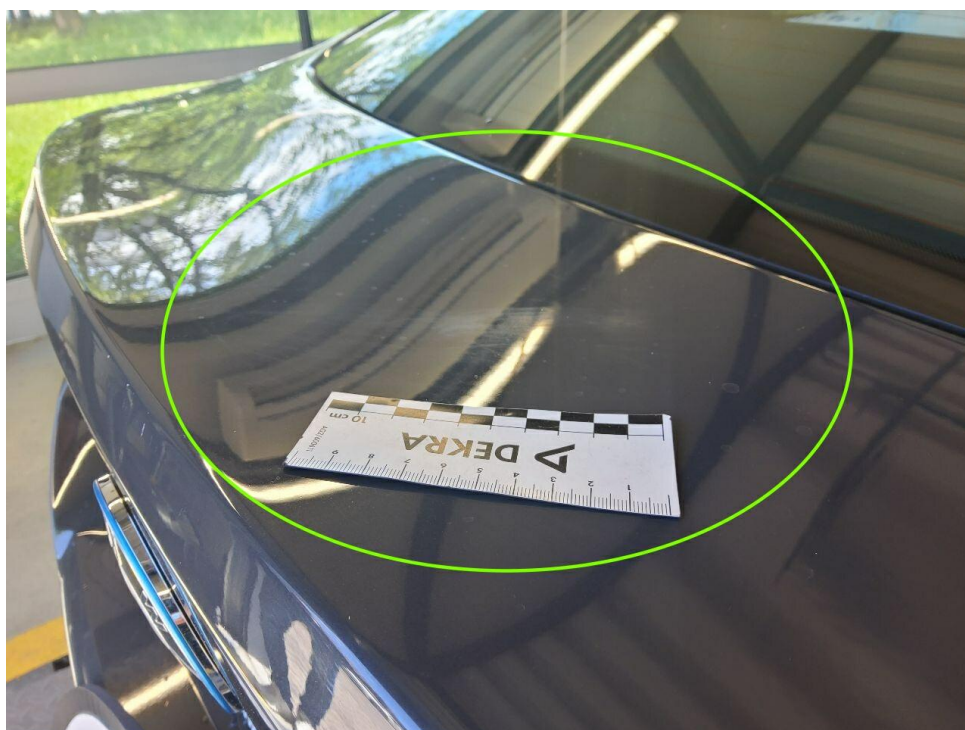
Bild 24 : Heckklappe, Oberflächlich verkratzt
