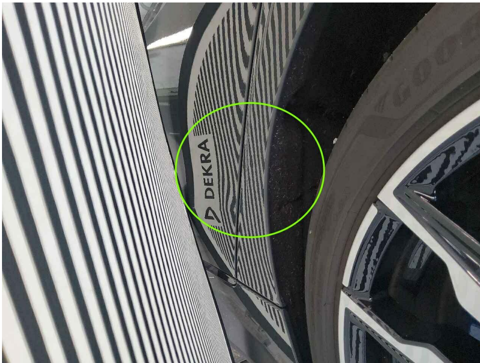
Bild 28 : Seitenteil links, eingedellt
