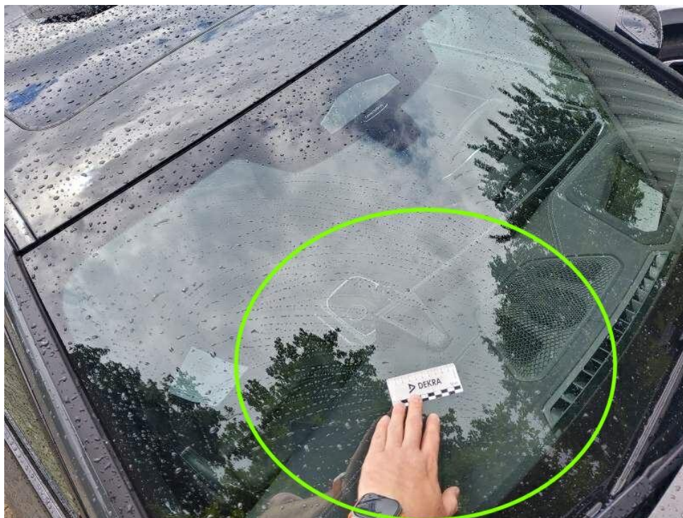
Bild 34 : Windschutzscheibe, Steinschlag mit Rissbildung
