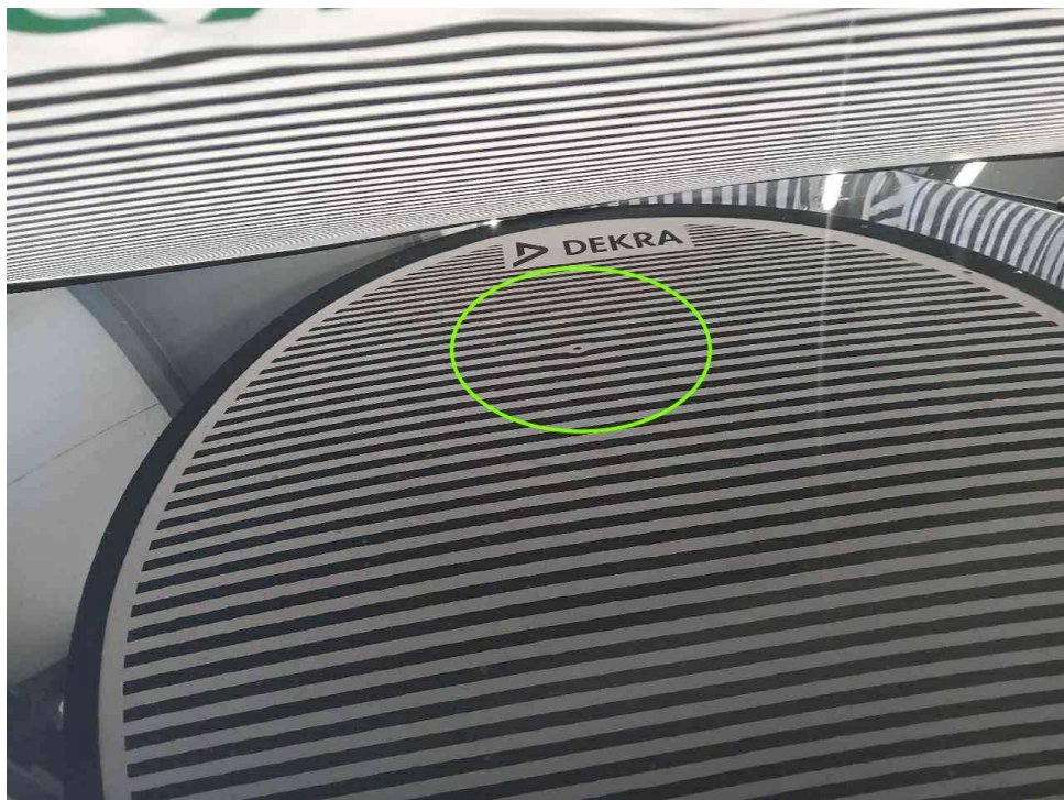
Bild 20 : Motorhaube, eingedellt, vereinzelte Steinschläge
