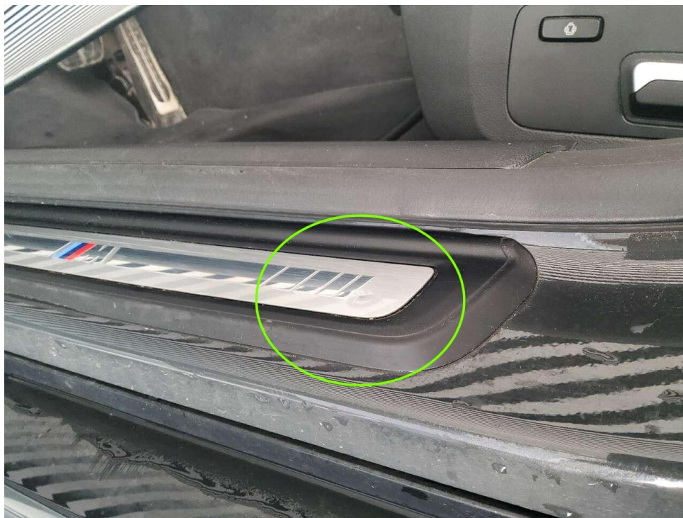
Bild 26 : Einstiegsleiste vorne links, eingedellt
