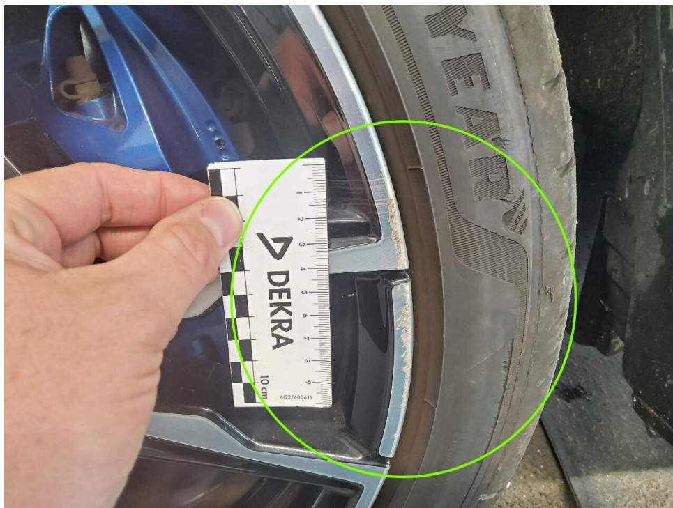
Bild 25 : Felge vorne links (glanzgedreht), verschrammt
