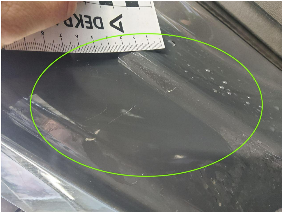
Bild 31 : Einstieg hinten rechts, zerkratzt
