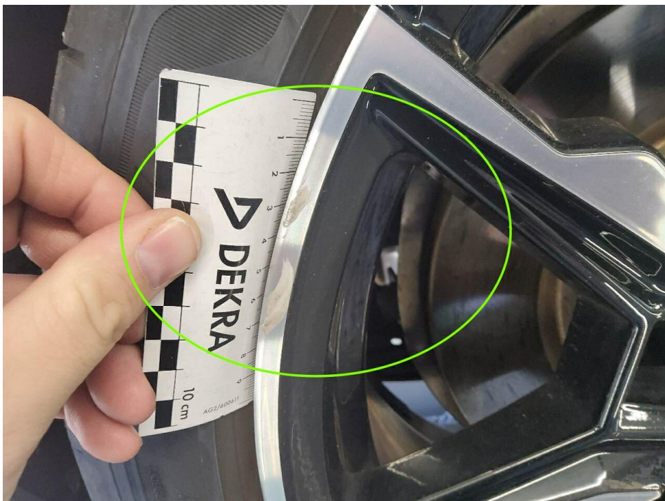
Bild 30 : Felge hinten rechts (glanzgedreht), verschrammt
