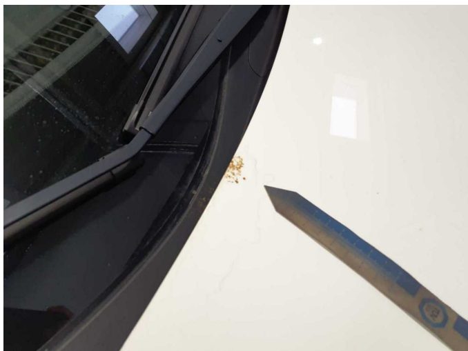
Damage 16: Body: Body (Anätzung-Mehrkosten möglich) - Paint defect - Conditioning
