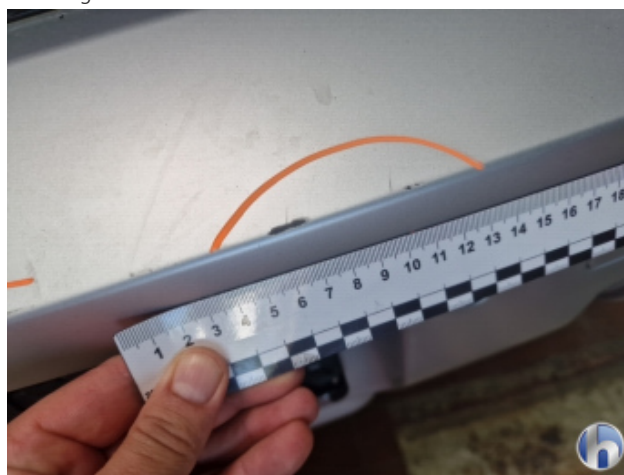
1. Stoßfänger Hinten Kratzer - Smart Repair
