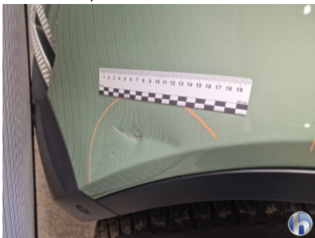
3. Kotflügel Vorne - Links Kratzer - Smart Repair
