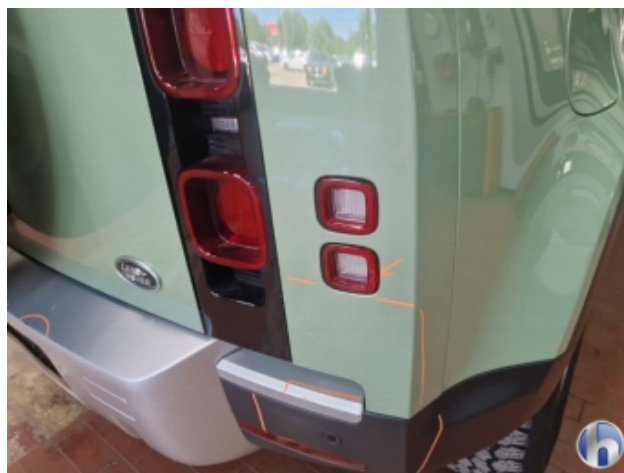
5. Rückleuchte Rechts Beschädigt - Erneuern
