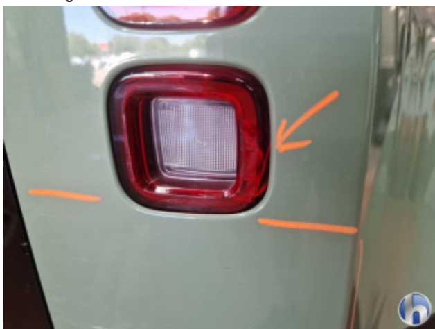
5. Rückleuchte Rechts Beschädigt - Erneuern
