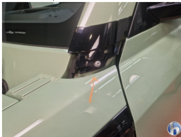
4. A-Säule Vorne - Links Beschädigt - Erneuern
