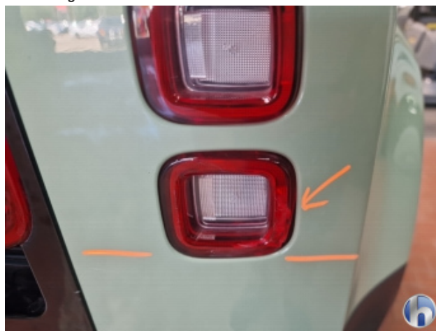
5. Rückleuchte Rechts Beschädigt - Erneuern
