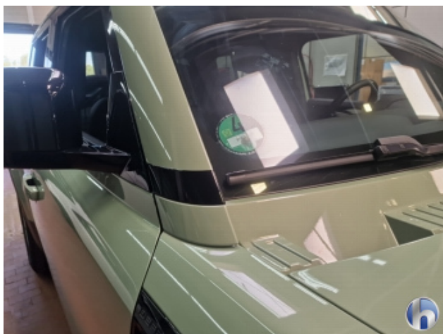
4. A-Säule Vorne - Links Beschädigt - Erneuern
