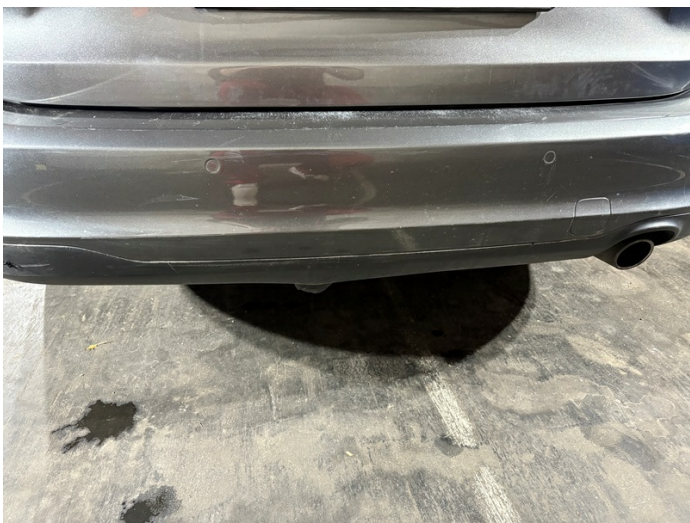
Stoßfänger Diffusor hinten: verschrammt (Foto 13)
