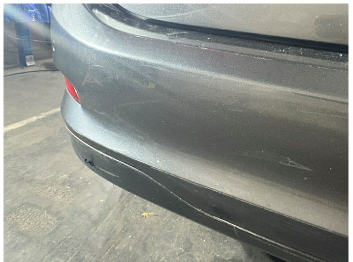
Stoßfänger Diffusor hinten: verschrammt (Foto 14)
