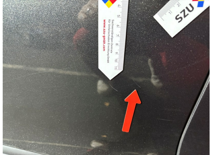
Tür hinten rechts: Kratzer (Foto 18)
