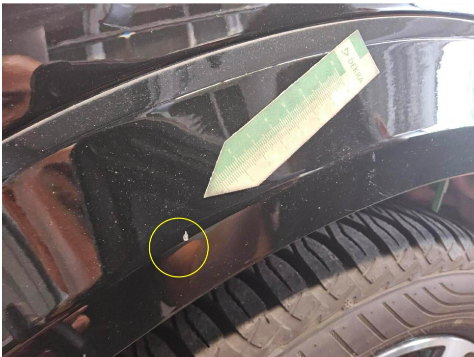
Bild 14 : Kotflügel vorne links Zierleiste Lackierung, Steinschlag, Gebrauchsspur
