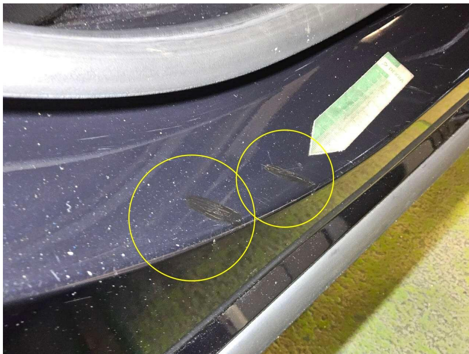
Bild 29 : Einstiegschweller hinten rechts, mit Lackstift den Kratzer ausgetupft
