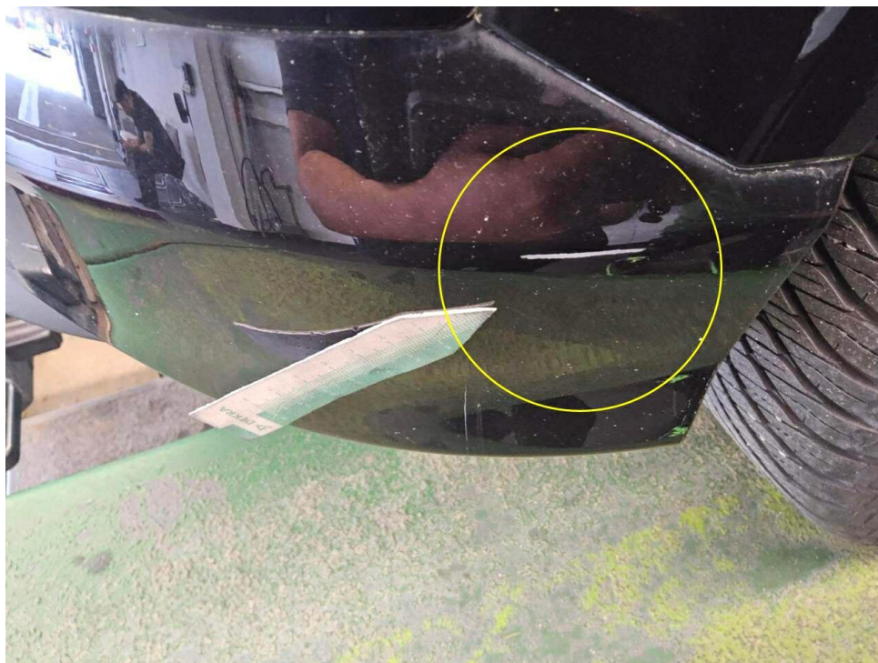
Bild 15 : Stoßfänger hinten Lackierung, zerkratzt, lackieren
