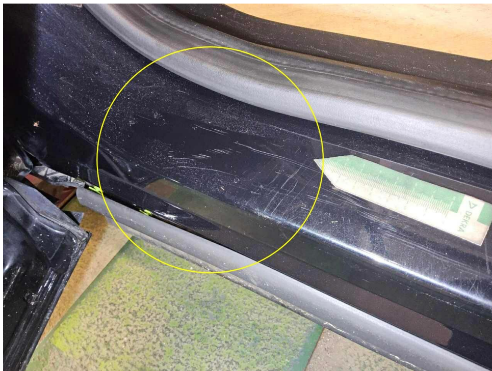
Bild 23 : Tür vorne links Einstieg Lackierung, zerkratzt, smart repair
