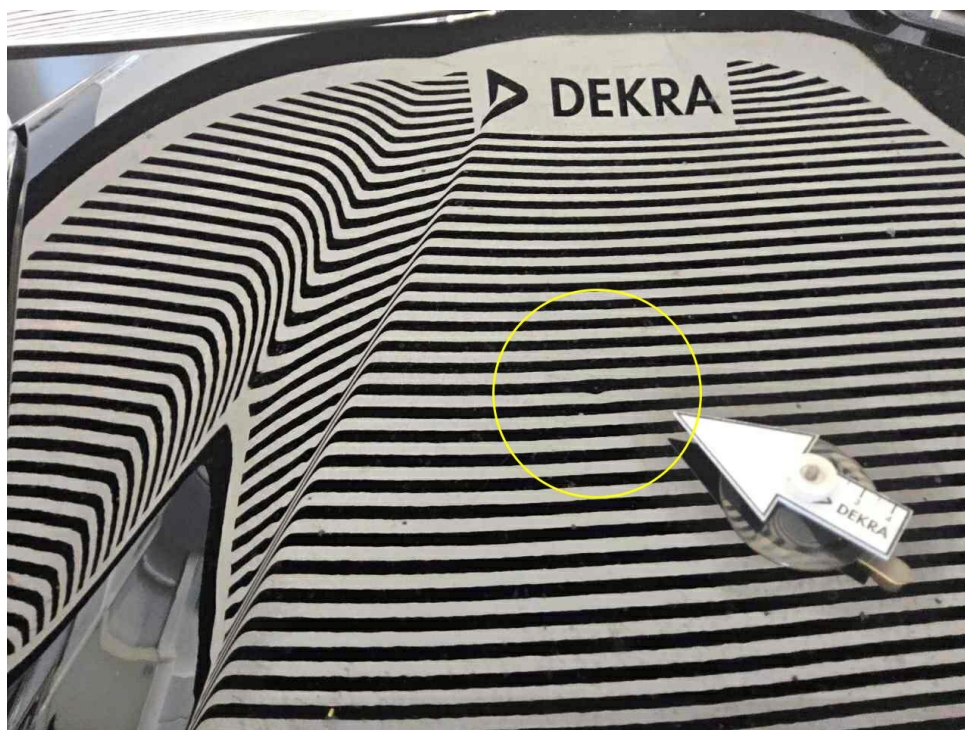
Bild 12 : Motorhaube, eingedellt, Gebrauchsspur
