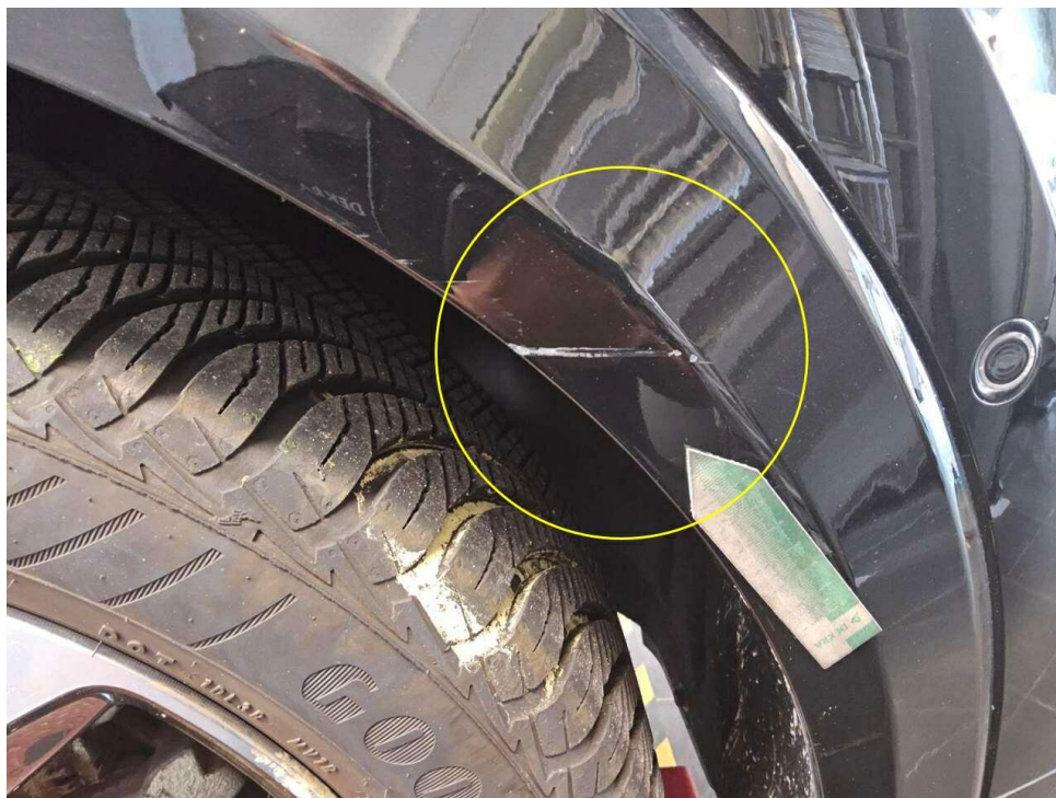
Bild 21 : Kotflügel vorne rechts Zierleiste Lackierung, verschrammt, smart repair
