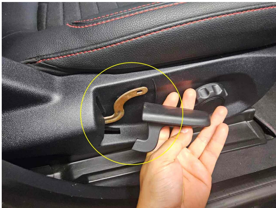
Bild 25 : Beifahrersitz Sitzhebel, gebrochen
