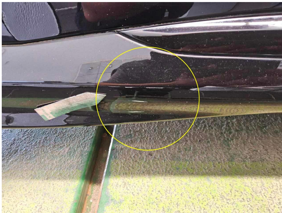
Bild 19 : Tür hinten rechts Schutzleiste unten Lackierung, fleckig, lackieren
