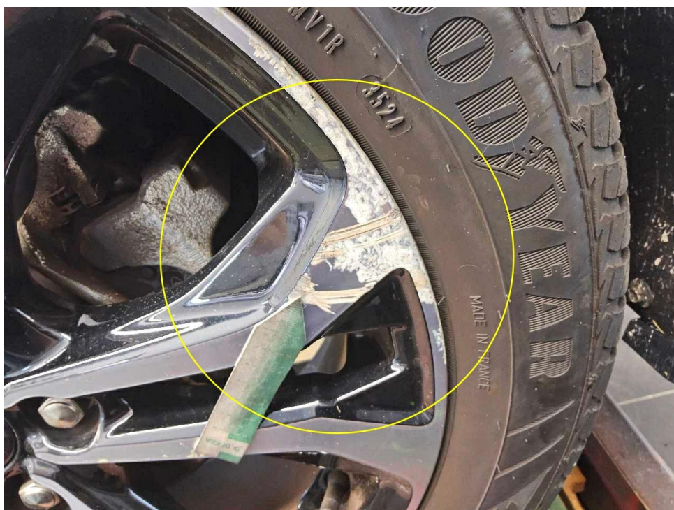
Bild 32 : Glanzgedrehte Alufelgen vorne rechts, ringsum verschrammt
