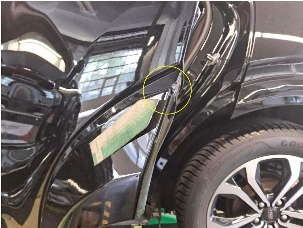
Bild 13 : Tür hinten links Zierleiste mitte Lackierung, verschrammt, smart repair
