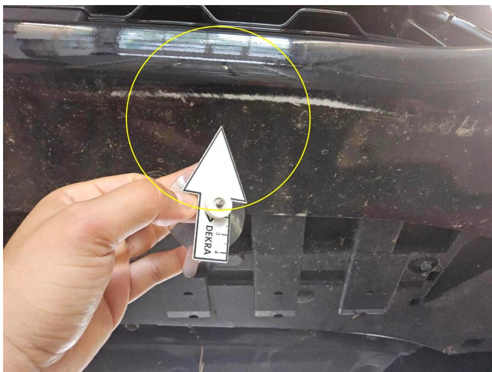
Bild 22 : Frontspoiler Lackierung, verschrammt, Gebrauchsspur
