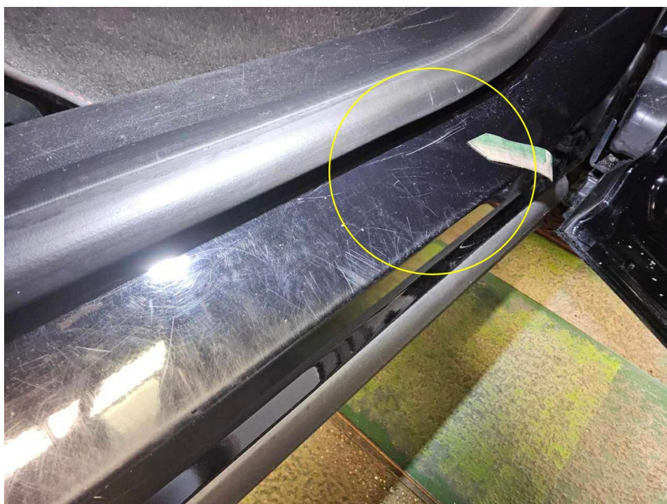
Bild 24 : Tür vorne rechts Einstieg Lackierung, zerkratzt, smart repair
