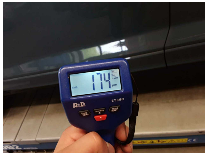
Door - front left side: 174 µm
