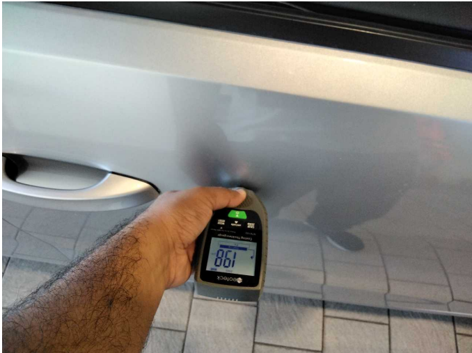
Door - front right side: 198 µm
