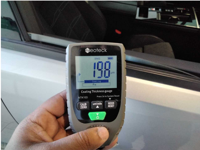
Door - front right side: 198 µm
