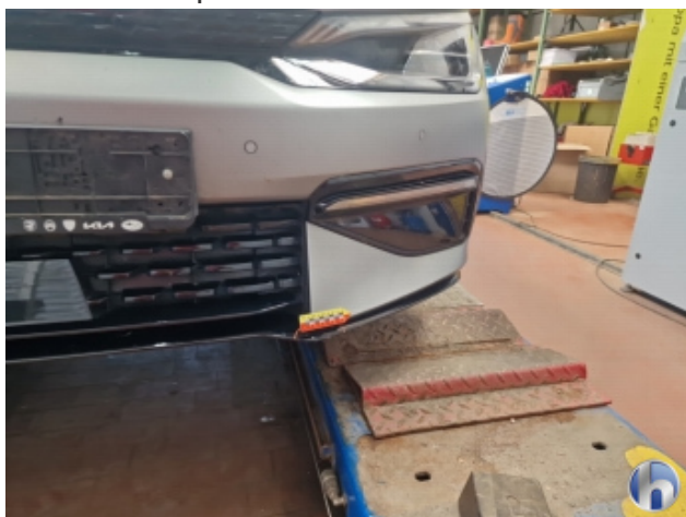
7. Frontspoiler Beschädigt - Smart Repair
