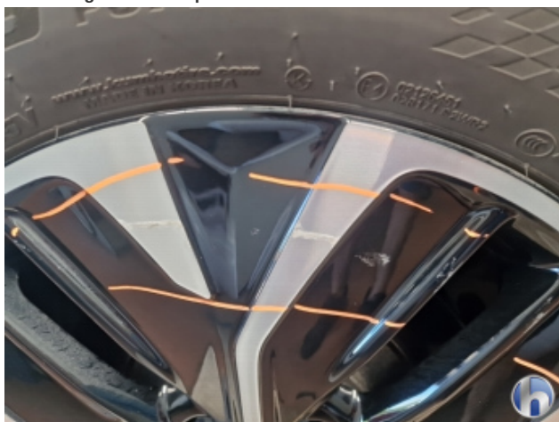
2. Felge Hinten - Rechts Beschädigt - Smart Repair
