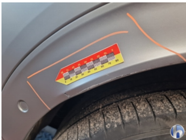
6. Seitenwand - Hinten - Rechts Kratzer - Smart Repair
