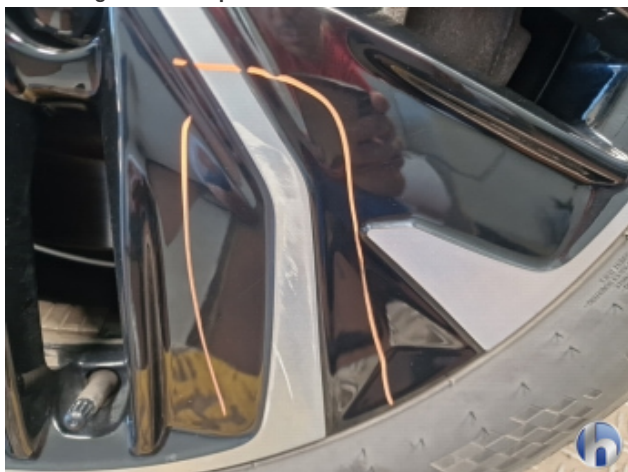
2. Felge Hinten - Rechts Beschädigt - Smart Repair
