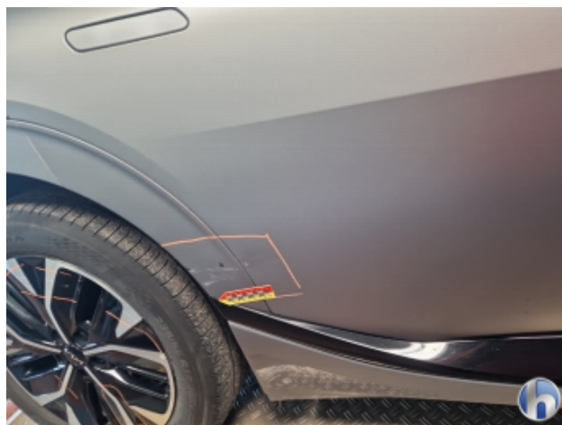
5. Tür Hinten - Rechts Beschädigt - Instandsetzen und Lackieren
