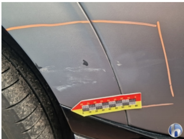
5. Tür Hinten - Rechts Beschädigt - Instandsetzen und Lackieren
