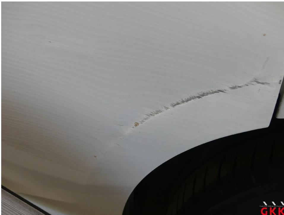
Bild 30 Tür hinten links, beschädigt, ersetzen
