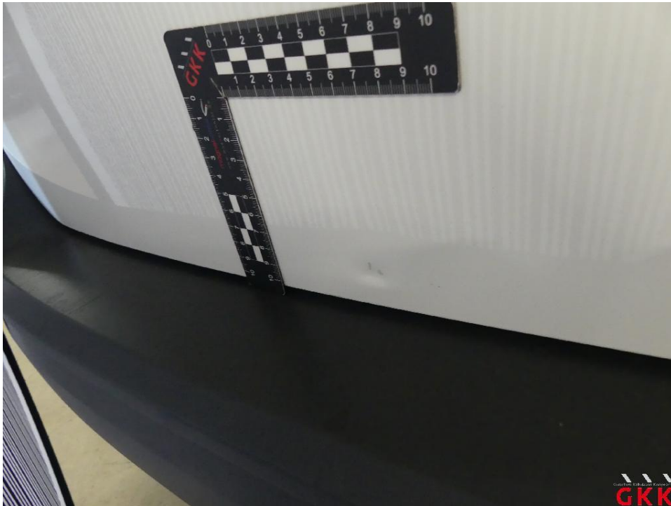
Bild 23 Heckklappe, beschädigt, instand setzen - lackieren
