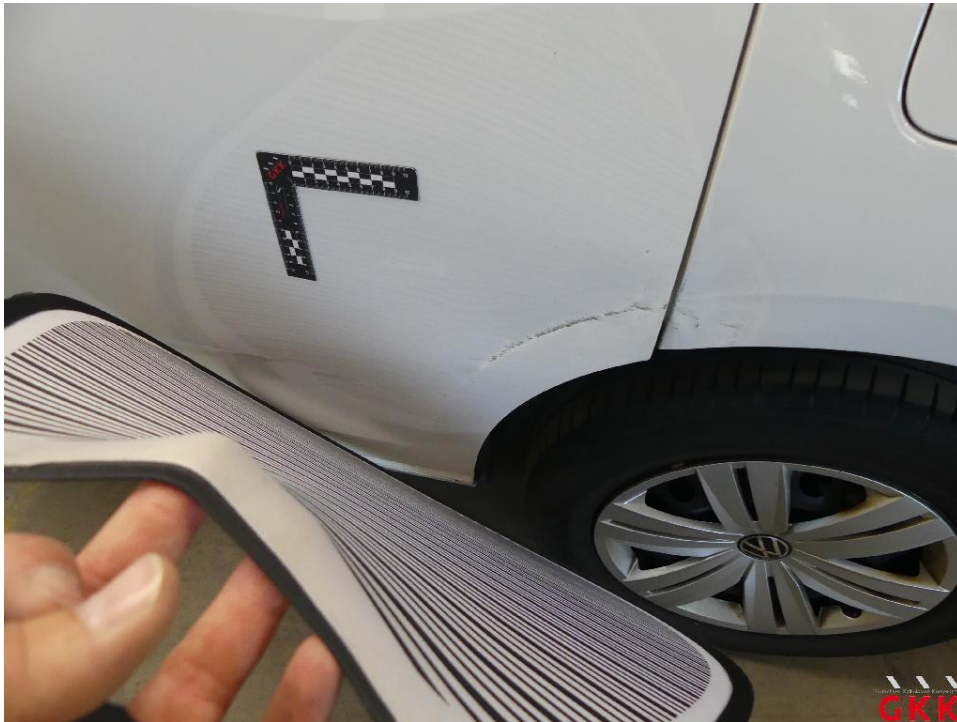
Bild 29 Tür hinten links, beschädigt, ersetzen
