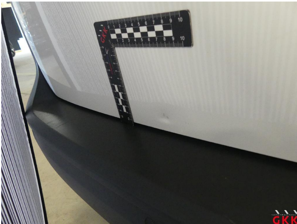
Bild 22 Heckklappe, beschädigt, instand setzen - lackieren
