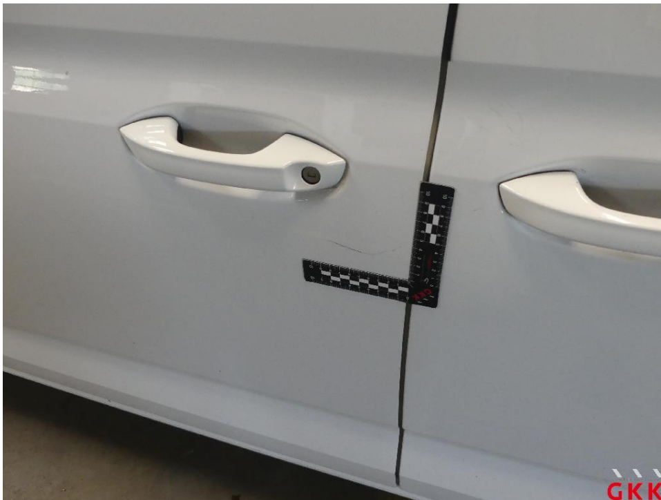
Bild 32 Tür vorne links, verkratzt, lackieren
