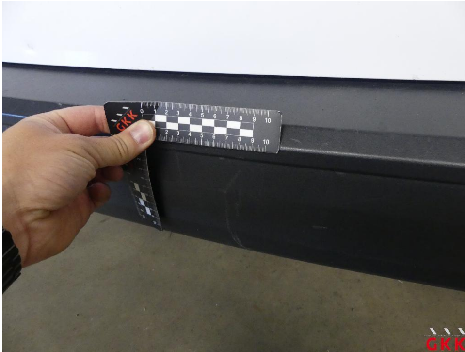
Bild 19 Stoßfänger hinten, Verkleidung -unlackiert-, verkratzt, ersetzen
