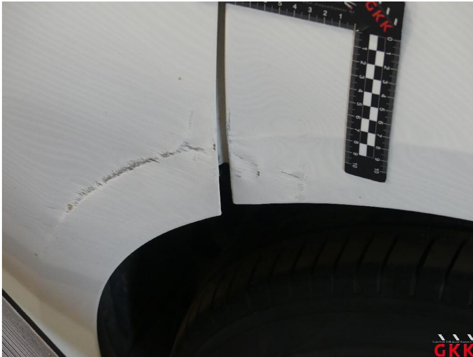
Bild 27 Seitenwand links, beschädigt, instand setzen - lackieren
