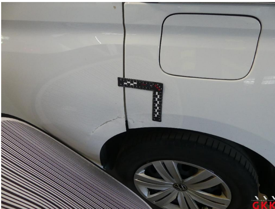
Bild 26 Seitenwand links, beschädigt, instand setzen - lackieren
