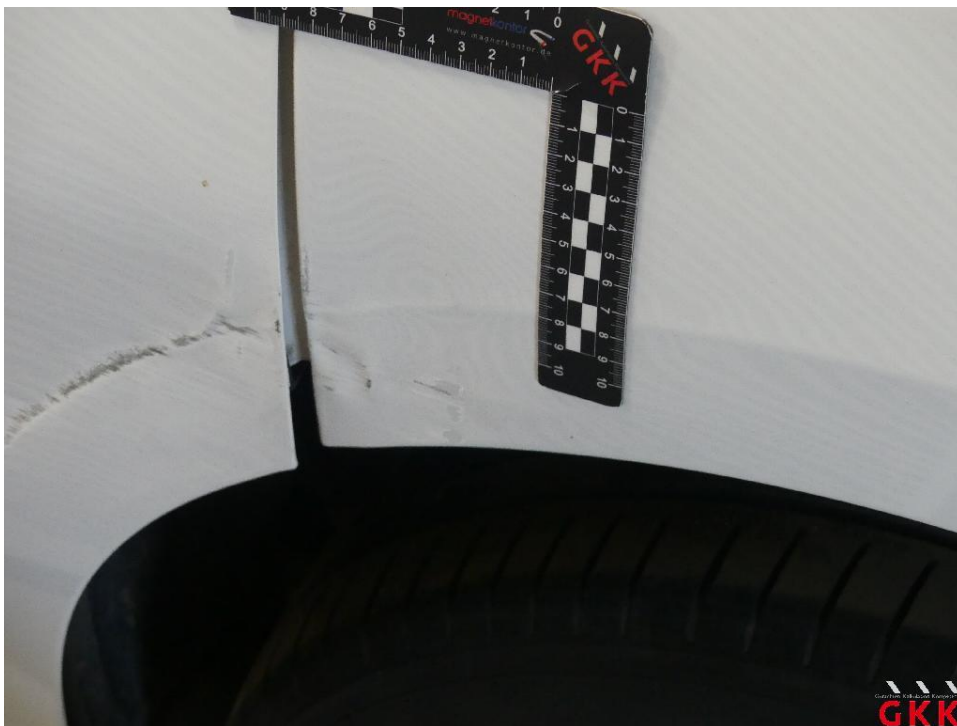
Bild 28 Seitenwand links, beschädigt, instand setzen - lackieren
