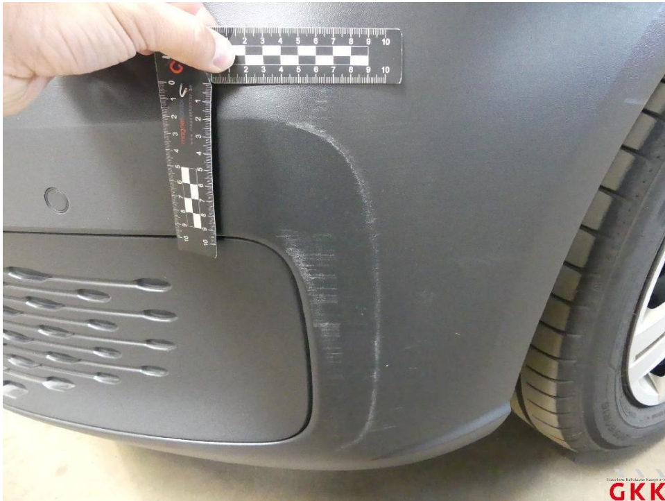
Bild 15 Stoßfänger vorne, Verkleidung -unlackiert-, verkratzt, ersetzen
