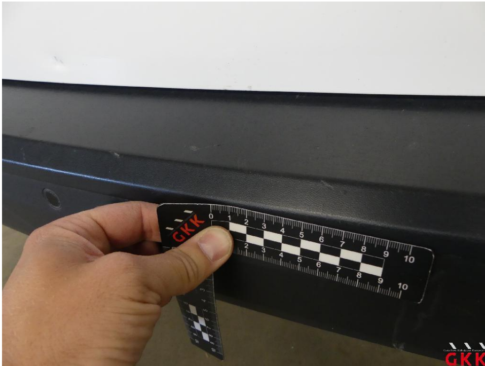
Bild 21 Stoßfänger hinten, Verkleidung -unlackiert-, verkratzt, ersetzen
