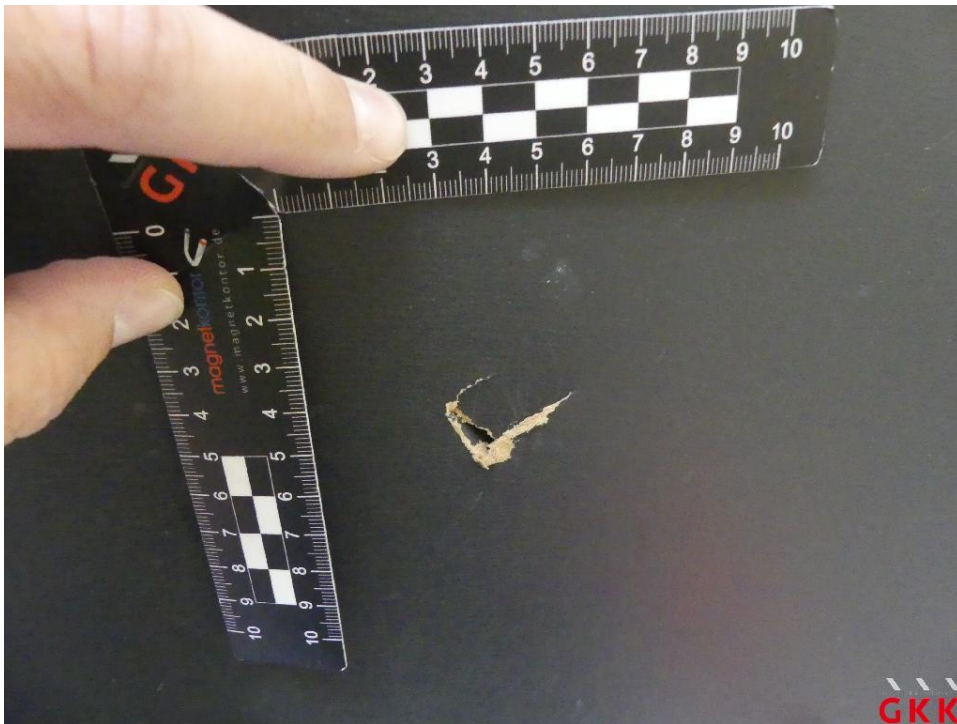
Bild 25 Heckklappe, Innenverkleidung, beschädigt, ersetzen
