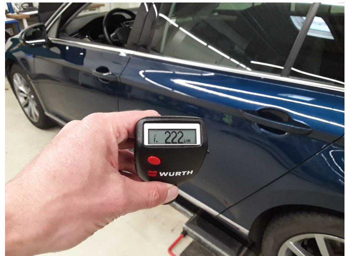
Door - rear left side: 222 µm
