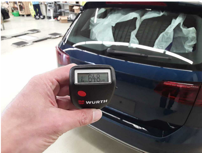
Boot lid / rear door: 648 µm
