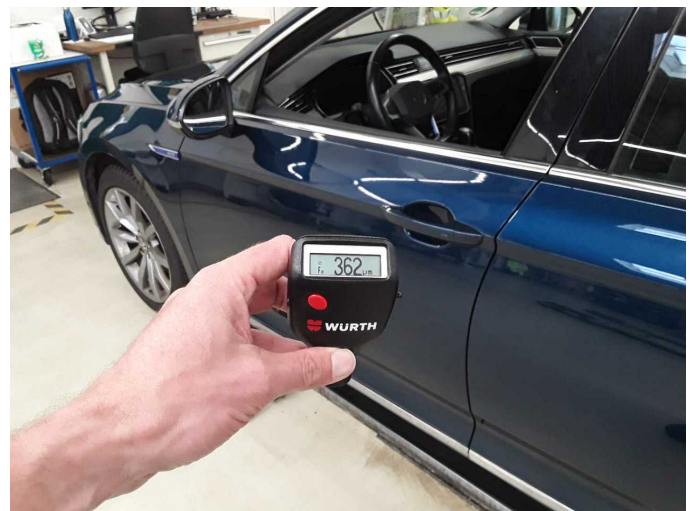
Door - front left side: 362 µm
