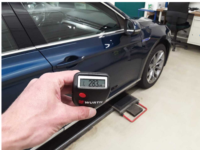
Door - front right side: 283 µm
