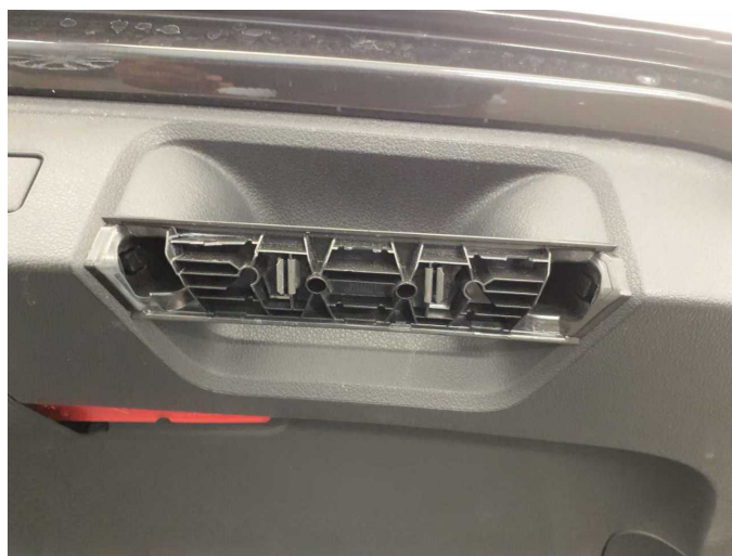
Damage 1: Boot lid / rear door: Door handle - inside (Abdeckung) - Missing - Replace
