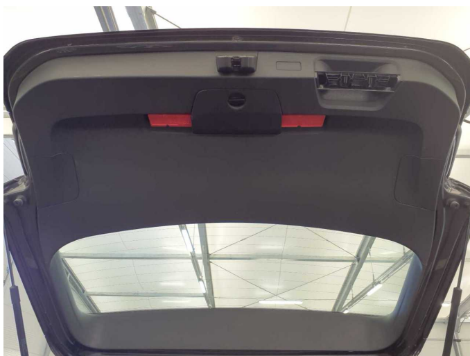
Damage 1: Boot lid / rear door: Door handle - inside (Abdeckung) - Missing - Replace
