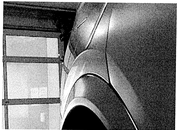
Beschädigung 9: Seitenwand links: Seitenwand - Delle / Lackschaden - lackieren
