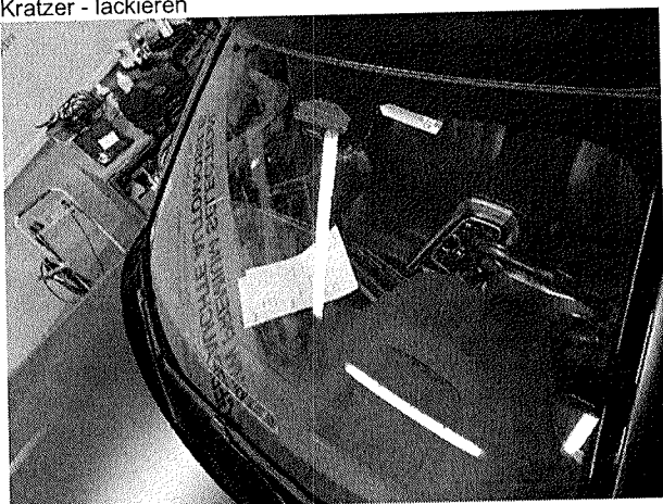
Beschädigung 14: Verglasung: Frontscheibe mit Spurhalteassistent (Mit Rissbildung, Kosten geschätzt) -
