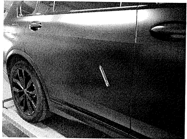
Beschädigung 8: Tür hinten rechts: Tür - Kratzer - lackieren
