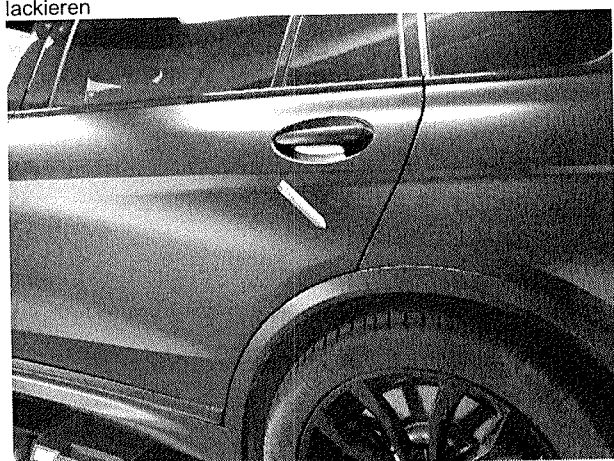
Beschädigung 11: Tür hinten links: Tür - Delle / Lackschaden - instandsetzen und lackieren
