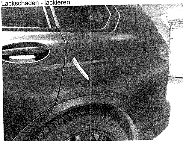
Beschädigung 10: Seitenwand links: Seitenwand - Kratzer - lackieren
