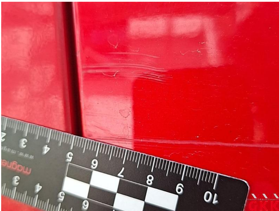
Bild 24. Schiebetür rechts, verkratzt, lackieren
