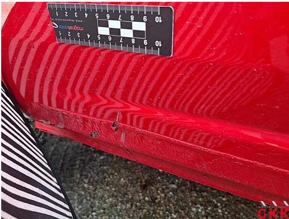
Bild 26. Seitenwand rechts, unterhalb, beschädigt, instand setzen - lackieren
