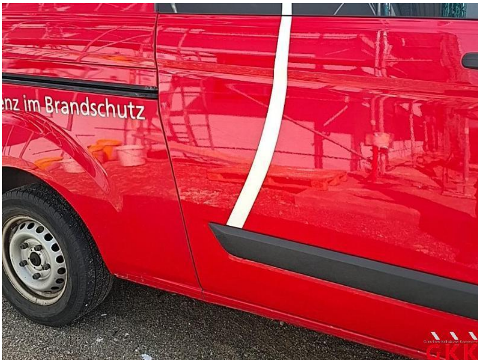
Bild 22. Schiebetür rechts, verkratzt, lackieren
