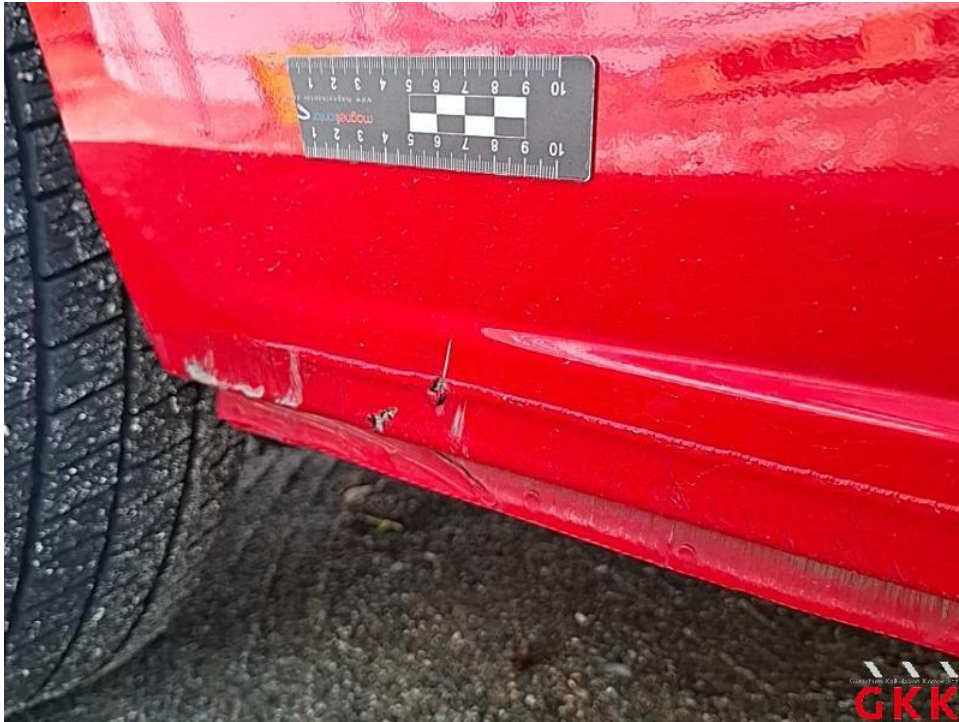
Bild 27. Seitenwand rechts, unterhalb, beschädigt, instand setzen - lackieren
