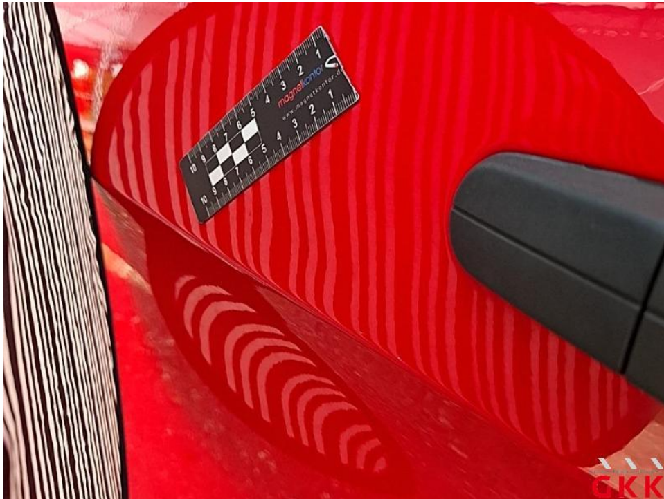
Bild 20. Schiebetür rechts, bis 3 Dellen / Bauteil, kalt drücken
