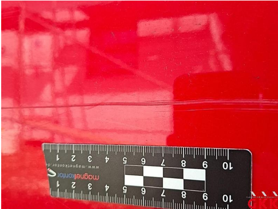
Bild 23. Schiebetür rechts, verkratzt, lackieren
