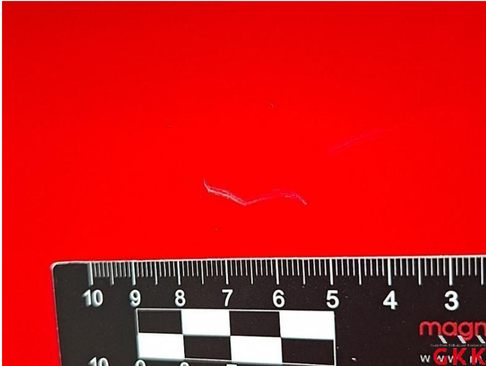
Bild 43. Tür vorne links, verkratzt, lackieren
