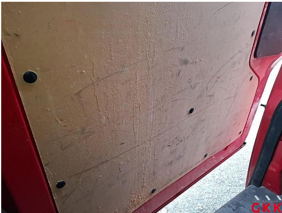
Bild 38. Schiebetür rechts, Innenverkleidung, beschädigt, ersetzen
