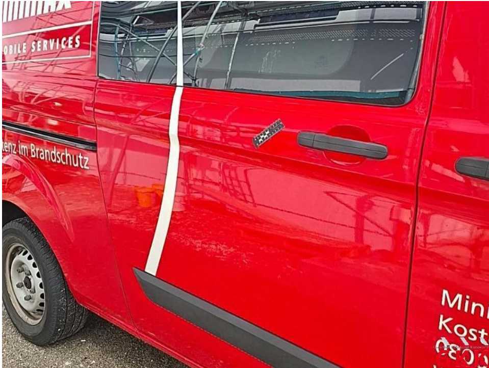
Bild 19. Schiebetür rechts, bis 3 Dellen / Bauteil, kalt drücken
