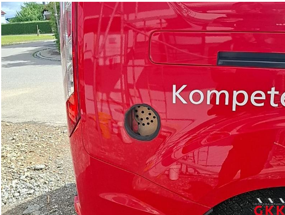
Bild 28. Seitenwand rechts, Be-/Entlüftungselement, fehlt, ersetzen
