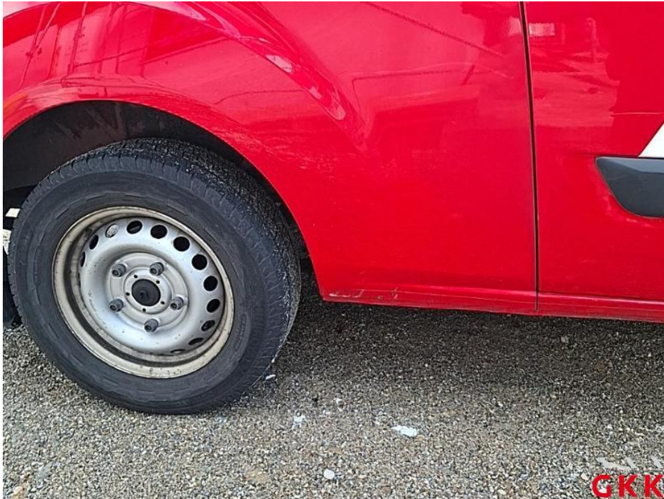
Bild 25. Seitenwand rechts, unterhalb, beschädigt, instand setzen - lackieren
