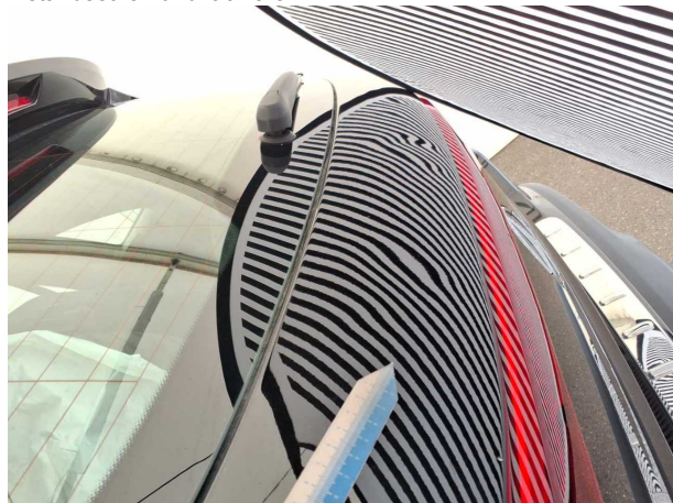
Beschädigung #7: Heckklappe/-tür: Heckklappe - Delle(n) - instandsetzen und lackieren
