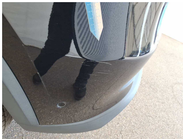
Beschädigung #4: Stossfänger hinten: Stossfänger hinten - Kratzer - Smart Repair
