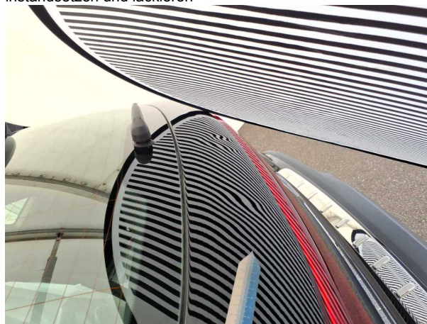
Beschädigung #7: Heckklappe/-tür: Heckklappe - Delle(n) - instandsetzen und lackieren
