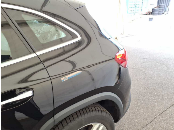
Beschädigung #1: Seitenwand links: Seitenwand - Delle(n) - sanft instandsetzen
