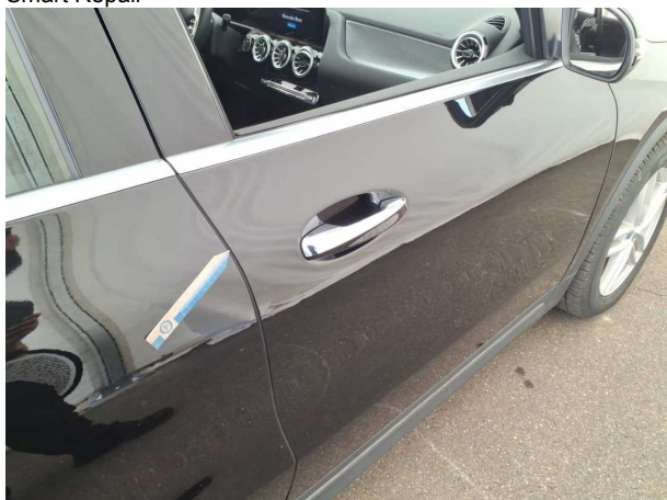
Beschädigung #5: Tür vorn rechts: Tür - Kratzer - Smart Repair
