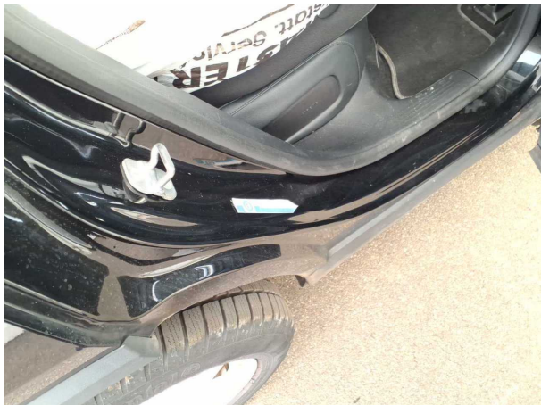
Beschädigung #2: Seitenwand rechts: Einstieg - Delle(n) - sanft instandsetzen
