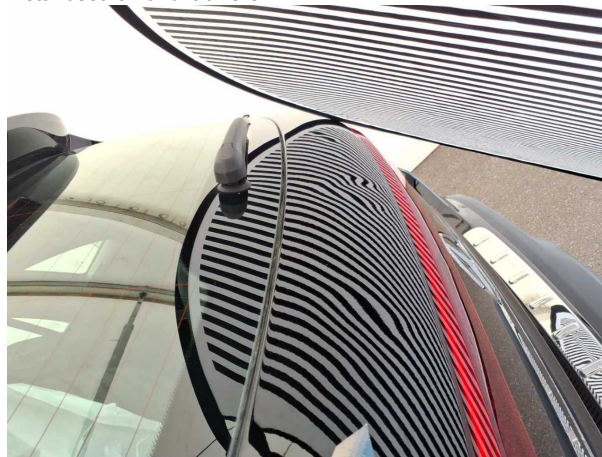
Beschädigung #7: Heckklappe/-tür: Heckklappe - Delle(n) - instandsetzen und lackieren
