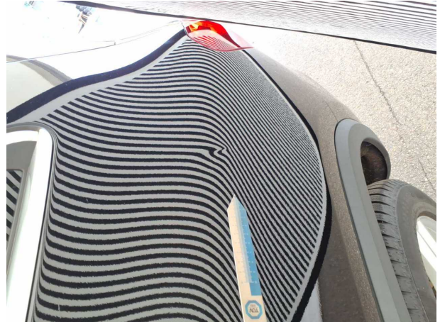
Beschädigung #1: Seitenwand links: Seitenwand - Delle(n) - sanft instandsetzen
