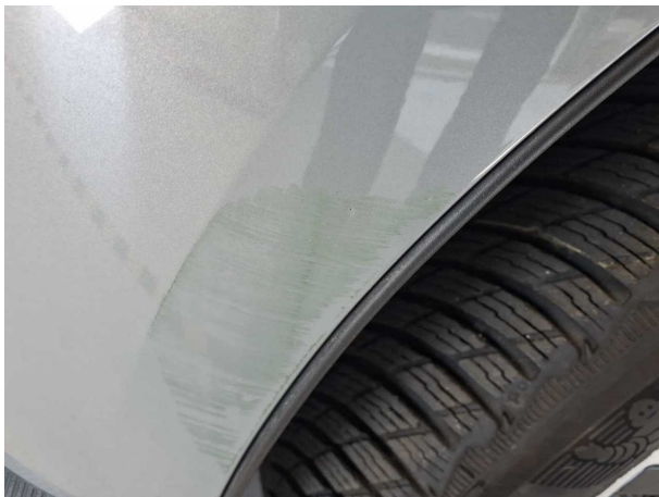
Beschädigung #6: Kotflügel links: Radlauf - beschädigt - erneuern
