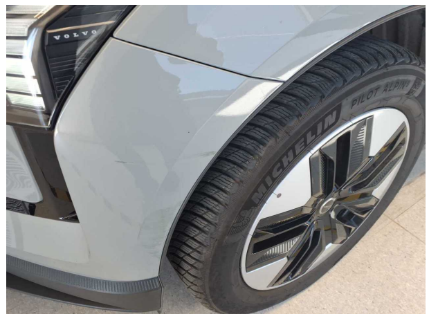
Beschädigung #6: Kotflügel links: Radlauf - beschädigt - erneuern
