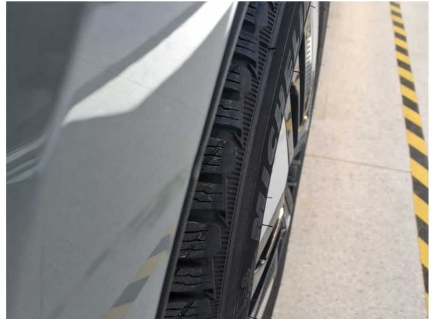
Beschädigung #6: Kotflügel links: Radlauf - beschädigt - erneuern
