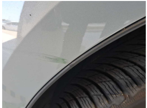
Beschädigung #6: Kotflügel links: Radlauf - beschädigt - erneuern
