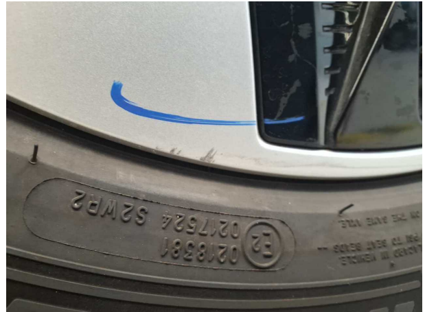
Beschädigung #9: Rad/Reifen: Leichtmetallfelge vorn rechts - Kratzer - erneuern
