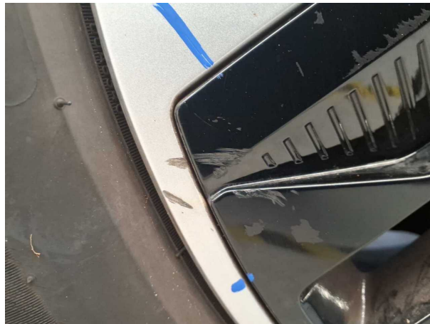
Beschädigung #1: Rad/Reifen: Raddeckel (Innere radblende hinten rechts) - beschädigt - erneuern
