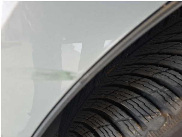
Beschädigung #6: Kotflügel links: Radlauf - beschädigt - erneuern
