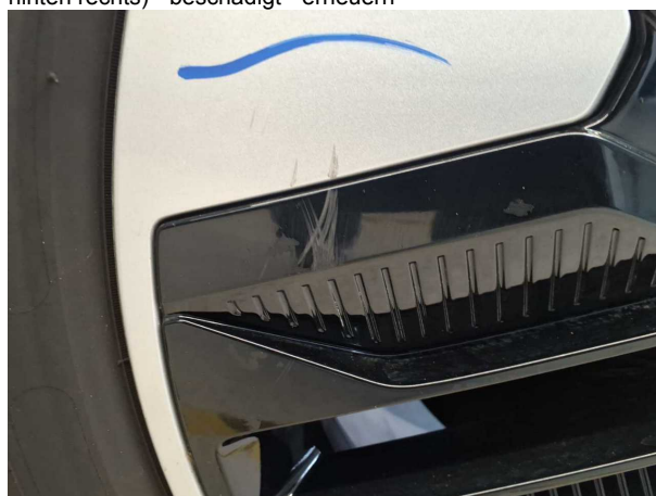
Beschädigung #2: Rad/Reifen: Raddeckel (Innere radblende vorne rechts) - beschädigt - erneuern
