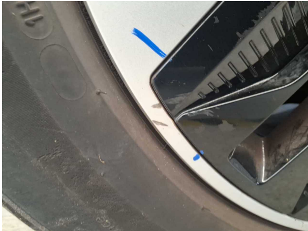
Beschädigung #7: Rad/Reifen: Leichtmetallfelge hinten rechts - Kratzer - Wertminderung
