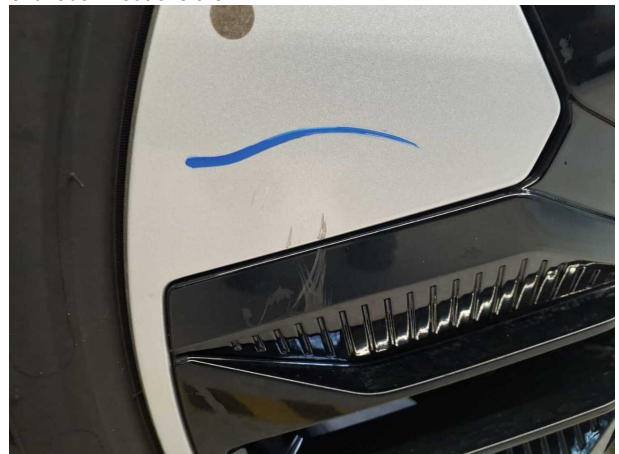
Beschädigung #9: Rad/Reifen: Leichtmetallfelge vorn rechts - Kratzer - erneuern
