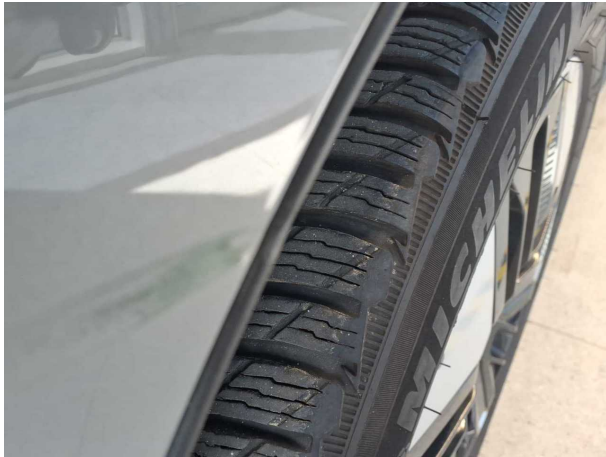
Beschädigung #6: Kotflügel links: Radlauf - beschädigt - erneuern
