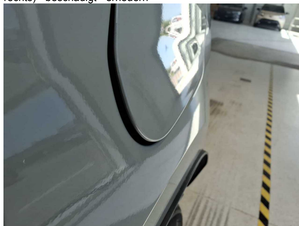
Beschädigung #3: Kraftstoffanlage: Tankklappe (Ecke;ist;nicht eingerastet) - lose - befunden ggf. instandsetzen
