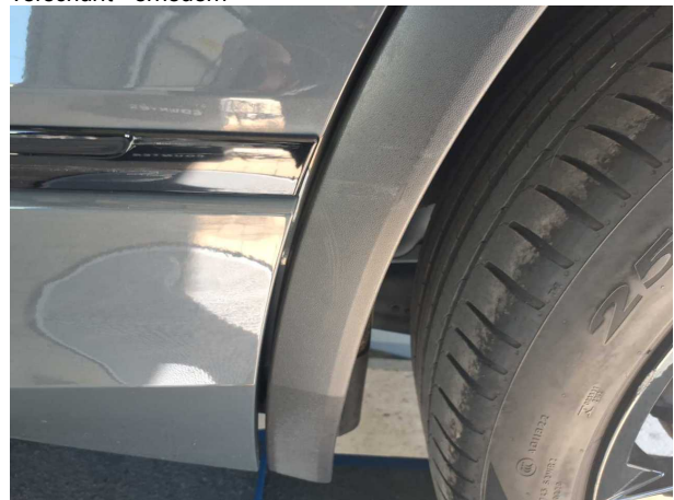
Beschädigung #2: Seitenwand links: Radlauf - Kratzer - erneuern
