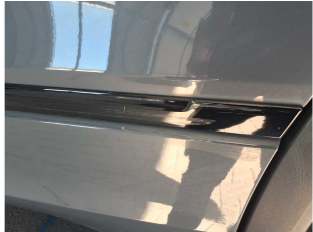
Beschädigung #1: Tür hinten links: Tür (Leiste) - verkratzt / verschürft - erneuern
