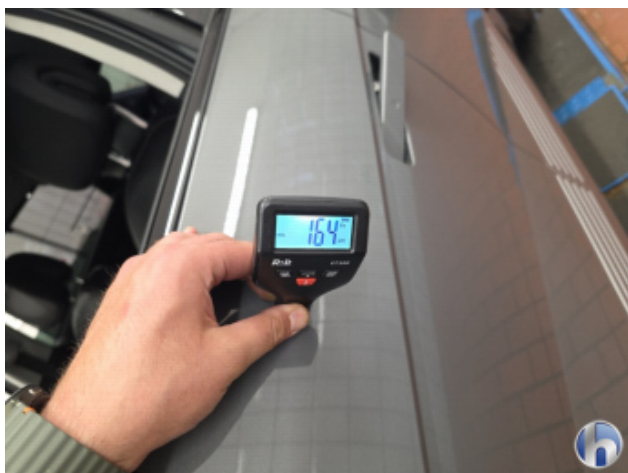
1. Tür Vorne - Links Nachlackiert - Ohne Reparatur
