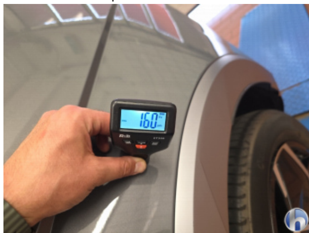
3. Seitenwand - Hinten - Links Nachlackiert - Ohne Reparatur
