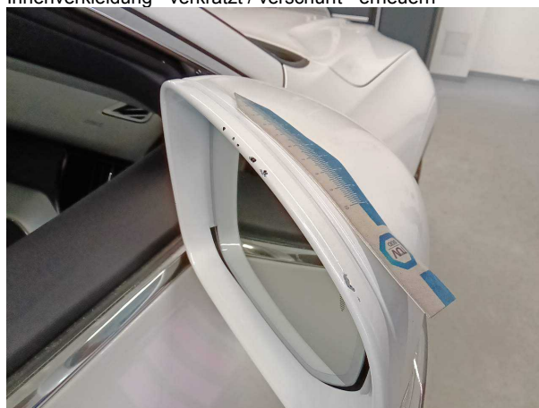
Beschädigung #2: Außenspiegel rechts: Abdeckkappe - Kratzer - Smart Repair
