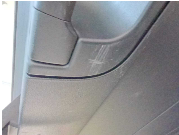
Beschädigung #1: Verkleidungen/Abdeckungen: Heckdeckel, Innenverkleidung - verkratzt / verschürft - erneuern
