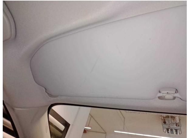
Beschädigung #3: Verkleidungen/Abdeckungen: Dachhimmel - verschmutzt - reinigen
