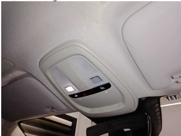
Beschädigung #3: Verkleidungen/Abdeckungen: Dachhimmel - verschmutzt - reinigen
