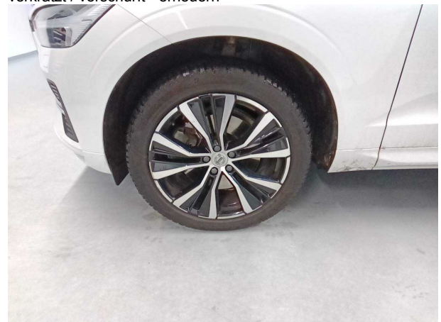
Beschädigung #7: Rad/Reifen: Leichtmetallfelge vorn links - verkratzt / verschürft - erneuern
