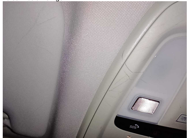
Beschädigung #3: Verkleidungen/Abdeckungen: Dachhimmel - verschmutzt - reinigen
