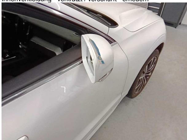
Beschädigung #2: Außenspiegel rechts: Abdeckkappe - Kratzer - Smart Repair
