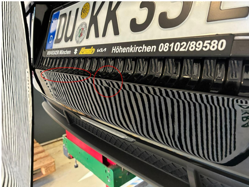
Bild 9 : Stoßfänger hinten Deko Kratzer + Kerben
