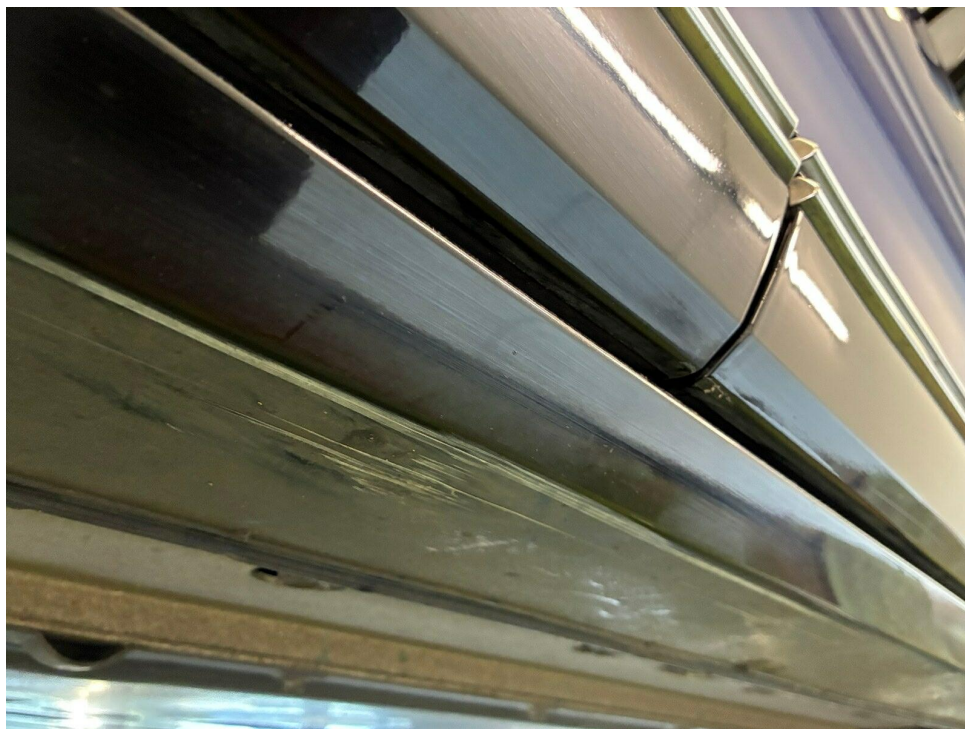
Bild 13 : Streifschaden rechts: Schweller + Türblende vorne
