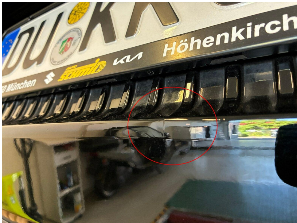
Bild 10 : Stoßfänger hinten Deko Kratzer + Kerben
